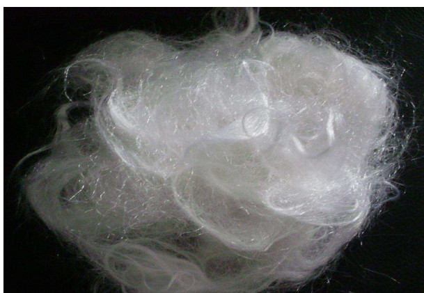
Εικόνα 1.4: Οι ίνες νάϋλον έχουν άψογη ελαστικότητα, μικρή απορρόφηση υγρασία και θερμοπλαστικότητα και χαμηλό κόστος
