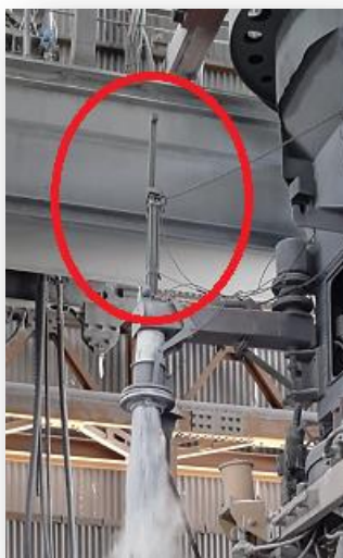
Εικόνα 7. Αισθητήρας για το σταμάτημα φόρτωσης αλουμίνας
