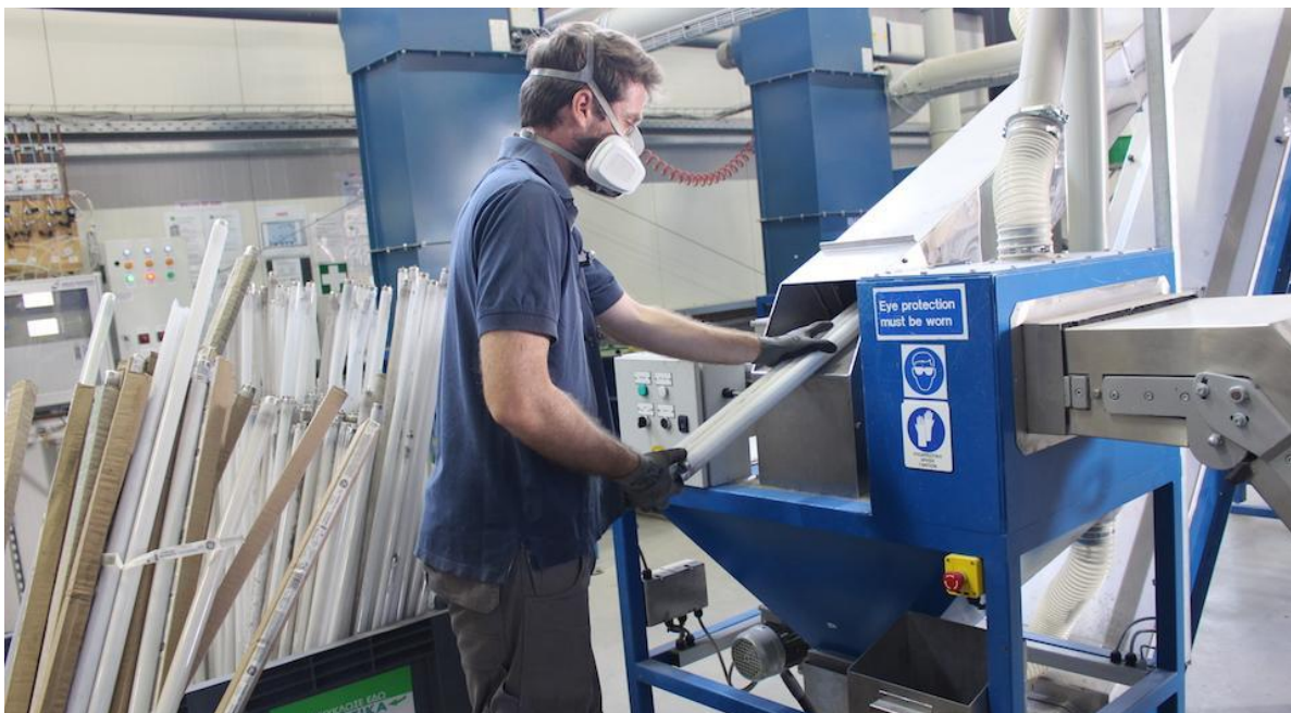
Εικόνα 5.4.3: Τοποθέτηση ευθύγραμμων λαμπτήρων φθορισμού στο μηχάνημα ανακύκλωσης.
