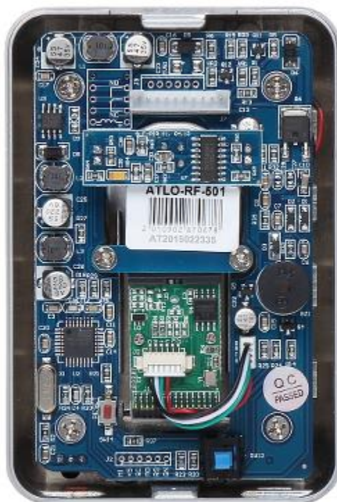
Εικόνα 1.6(Internal view RFID ATLO-RFM-501)
