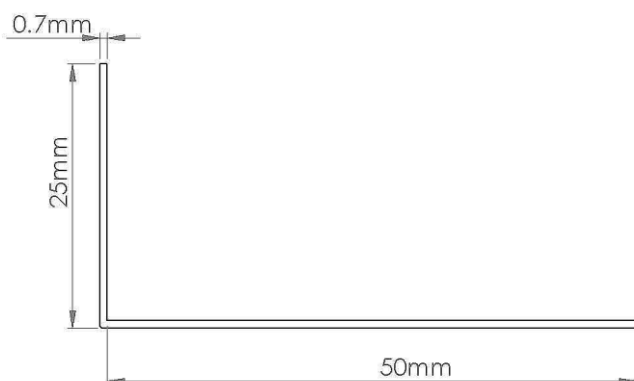
Εικόνα 13: Σκαρίφημα διατομής του λεπτού "πι" πάχους 0,7mm.
