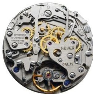
Εικόνα 2.1.3. Τα γρανάζια μέσα στον μηχανισμό του αυτόματου ρολογιού [63]
