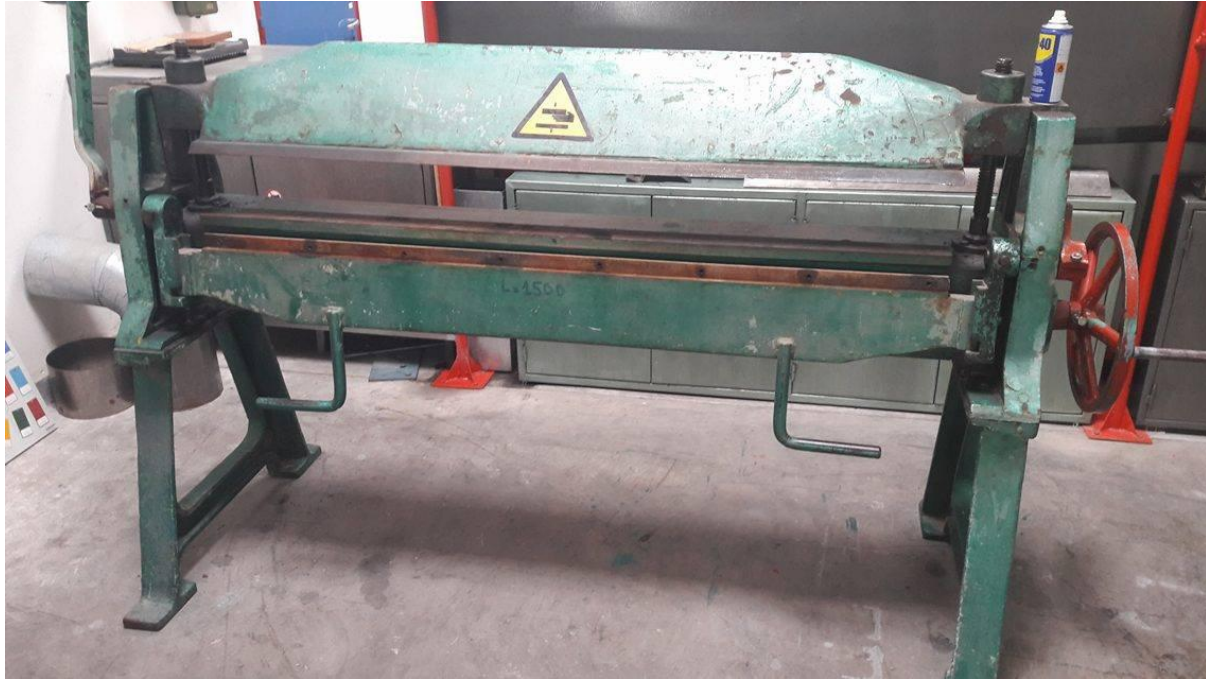
Εικόνα 4.2.2. Η στράντζα χωρίς το προστατευτικό κέλυφος.
