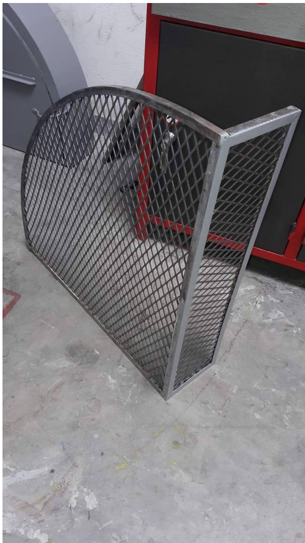
Εικόνα5.1.2. Επιδιορθωμένο προστατευτικό κέλυφος
