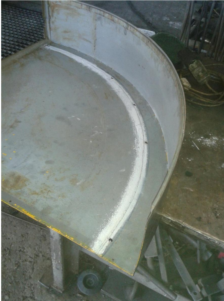
Εικόνα 6.3.1.1. Προετοιμασία για δημιουργία σχισμής
