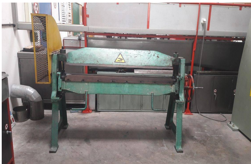
Εικόνα 4.2.1. Αρχική κατάσταση στράντζας πριν από τις εργασίες.
