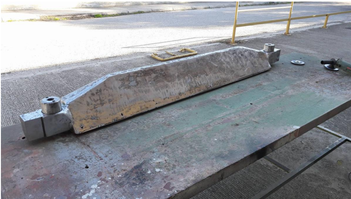
Εικόνα 5.3.1. Το κομμάτι της άνω σιαγόνας μετά την διαδικασία καθαρισμού από την μπογιά
