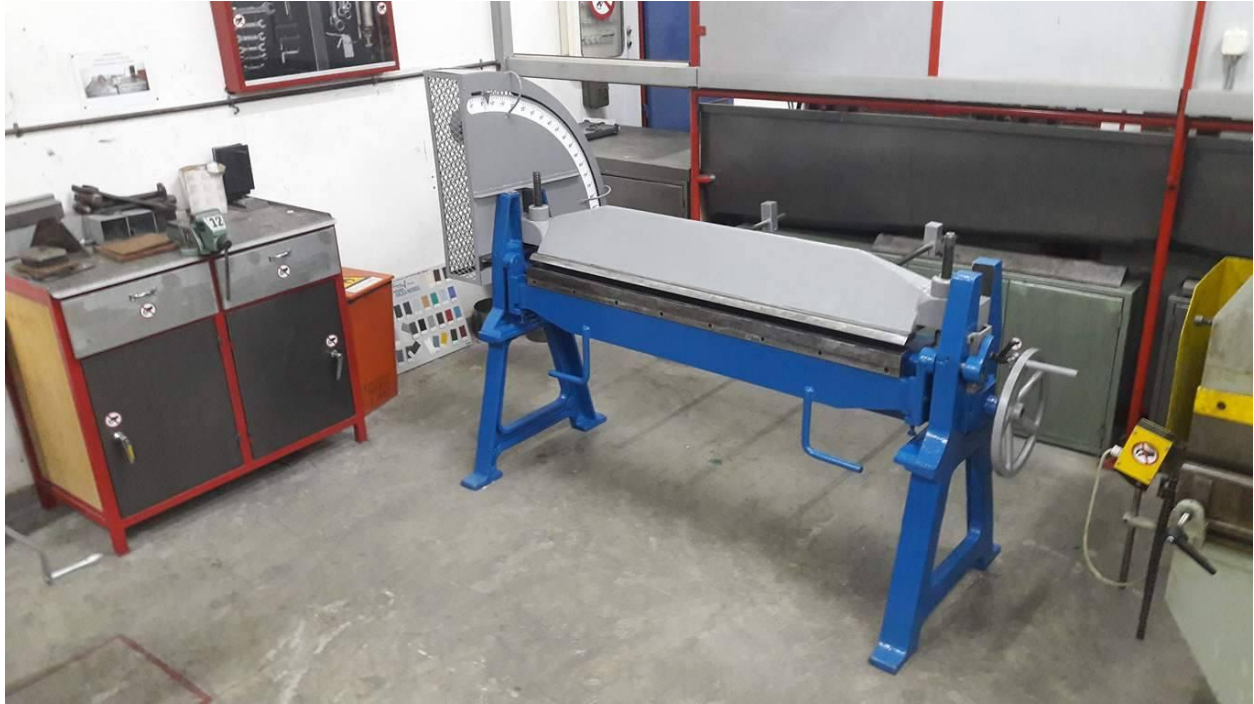
Εικόνα 7.1.8. Τελική μορφή στράντζας
