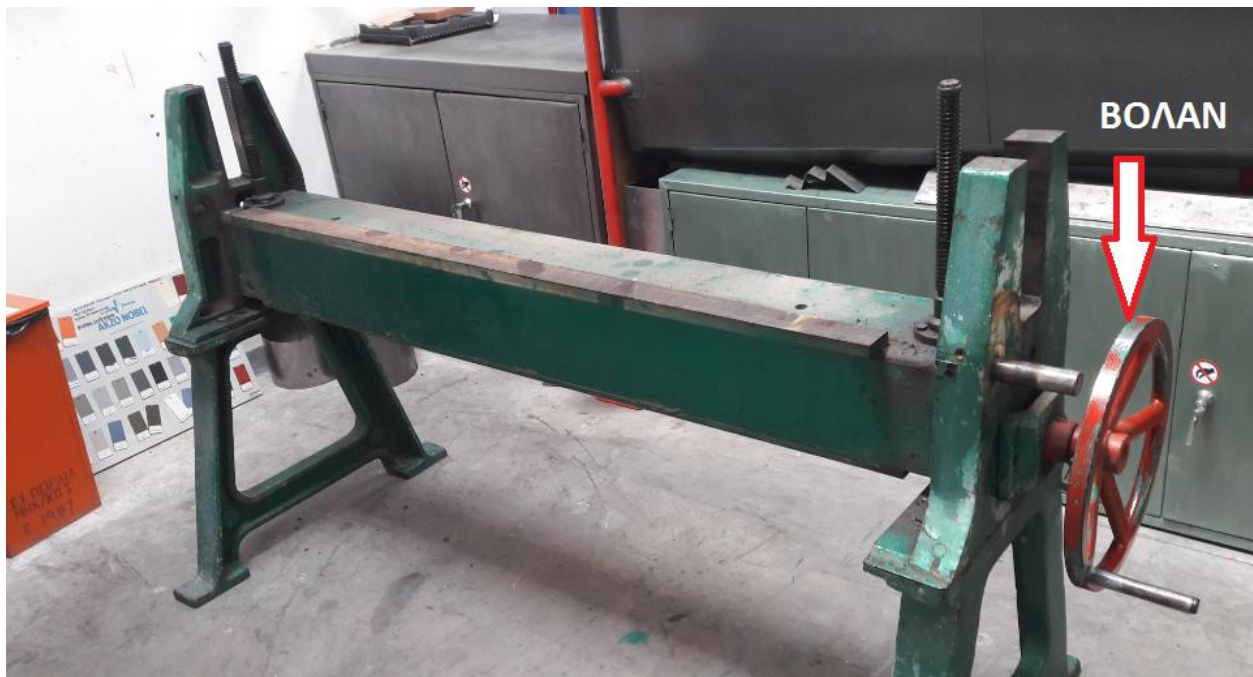
Εικόνα 4.2.5. Η στράντζα μετά την αποσυναρμολόγηση της άνω σιαγόνας.
