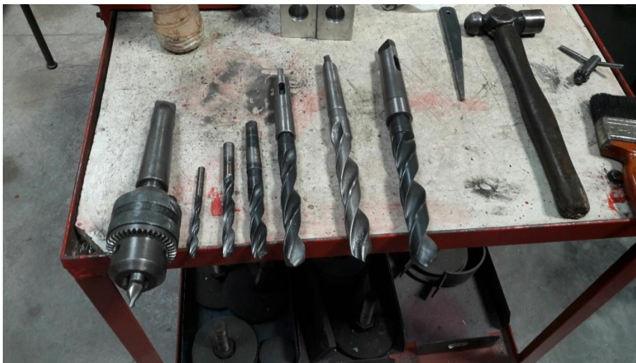
Εικόνα 6.1.3.1 Κοπτικά διάνοιξης οπής
