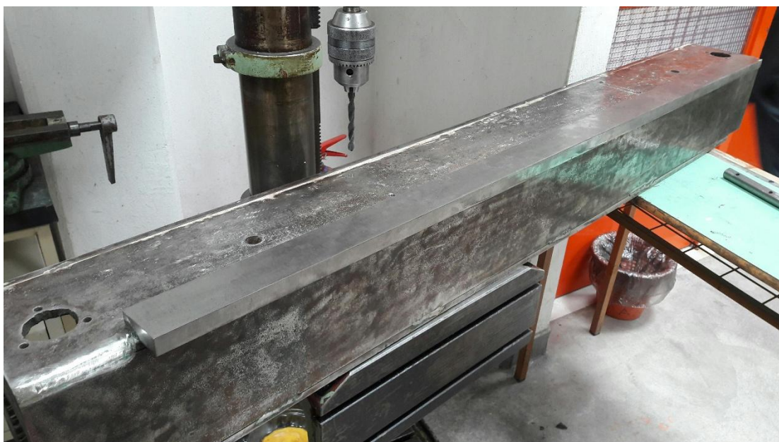
Εικόνα 6.1.2.1 Διάνοιξη οπών τραπεζιού
