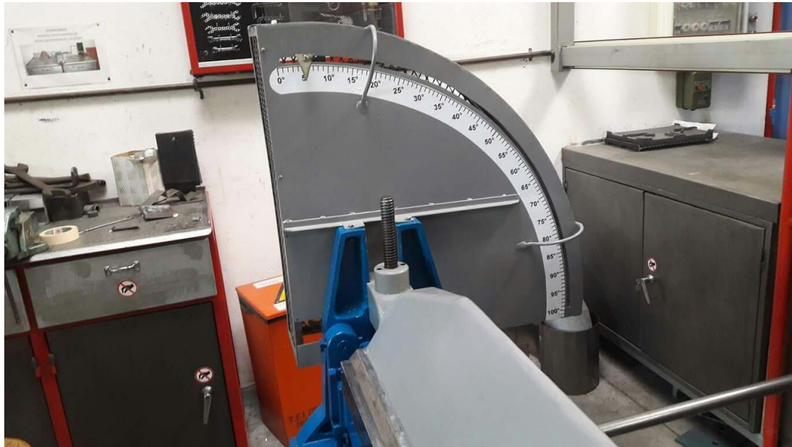
Εικόνα 6.3.3.1 Τελική μορφή μηχανισμού ένδειξης μοιρών
