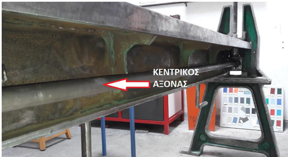
Εικόνα 4.2.6. Ο κεντρικός άξονας κίνησης της άνω σιαγόνας.
