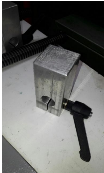
Εικόνα 6.1.3.3 Κινητό μέρος τερματικού με καστάνια M10
