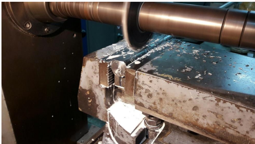
Εικόνα 6.1.1.2 Κατεργασία αφαίρεσης υλικού ράβδων
