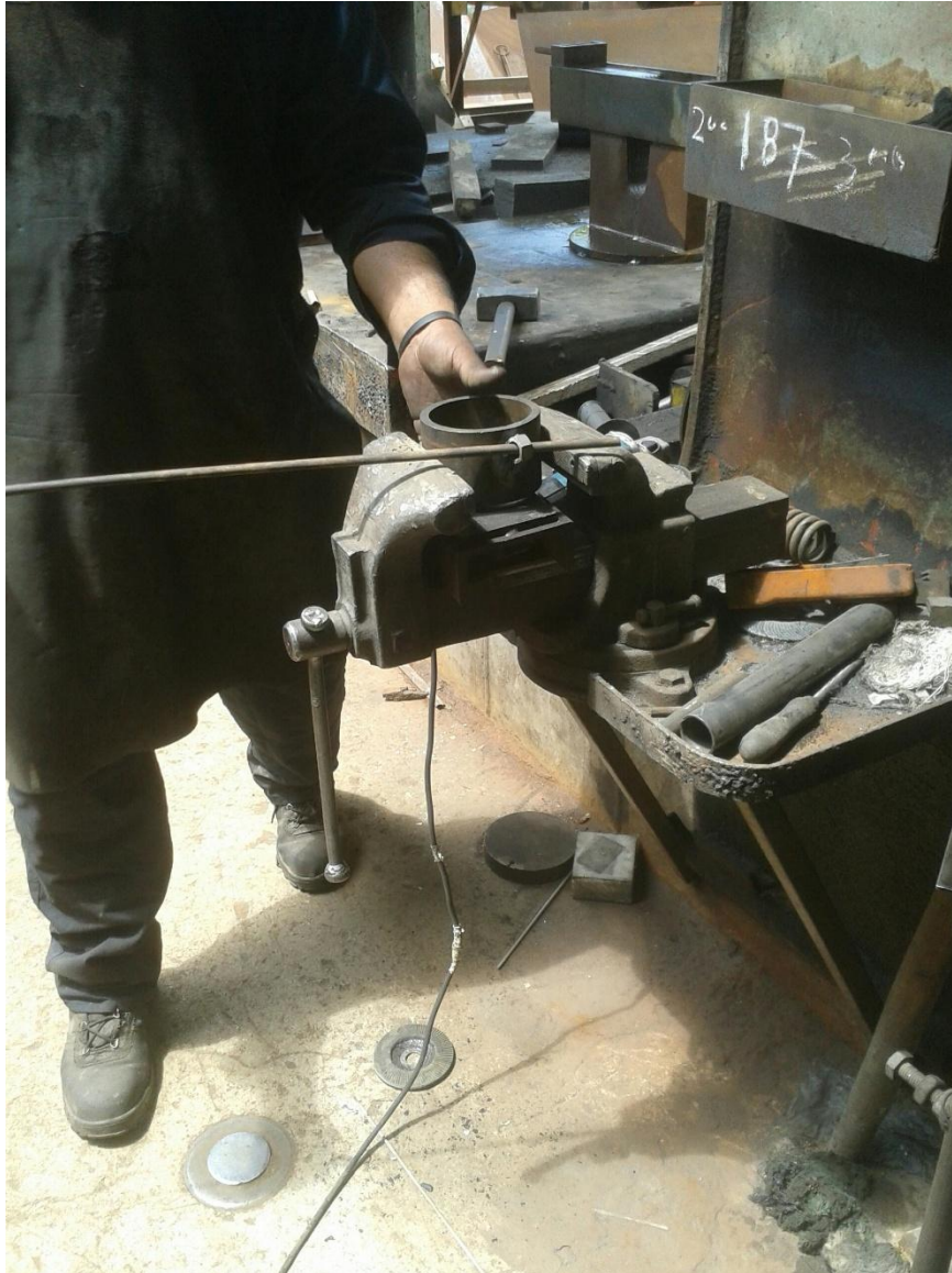
Εικόνα 6.3.1.3 Διαμόρφωση βέργας με ελεύθερη κάμψη
