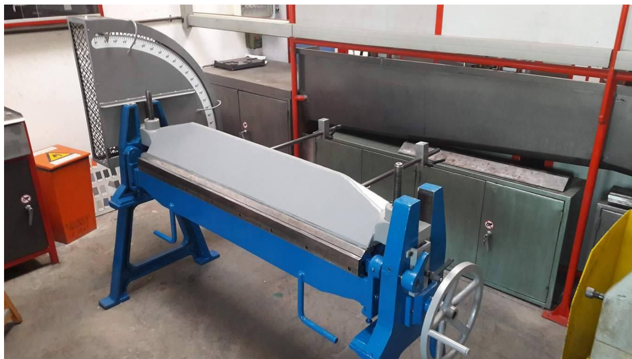
Εικόνα 7.1.7. Τελική μορφή στράντζας
