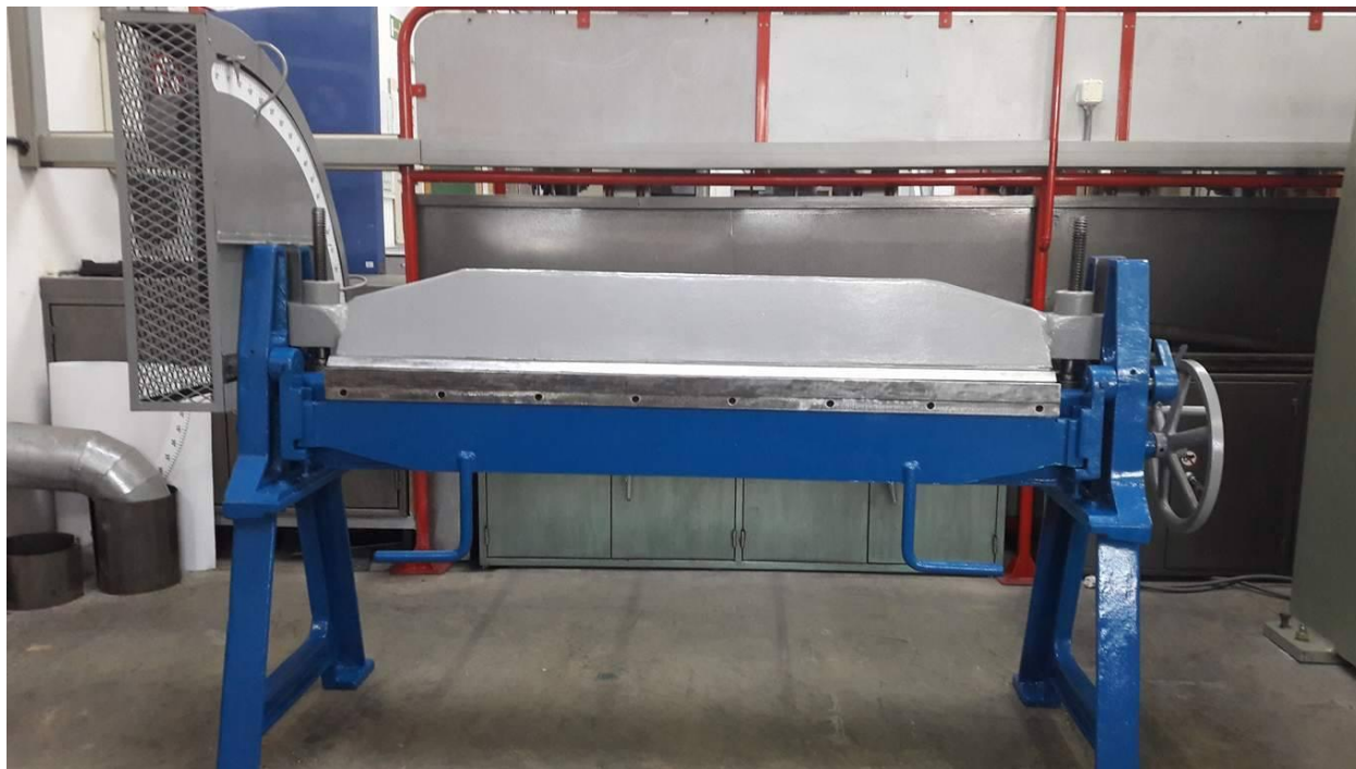
Εικόνα 7.1.6. Τελική μορφή στράντζας
