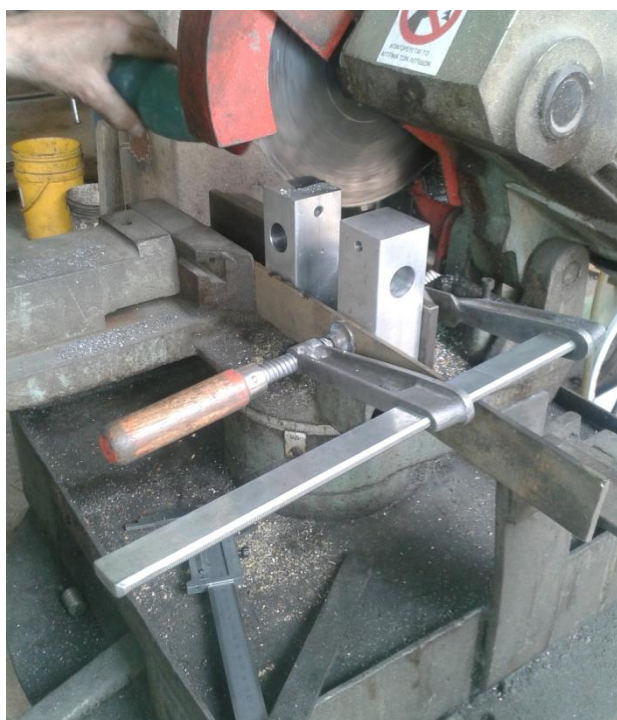
Εικόνα 6.1.3.2. Δημιουργία σχισμής κινητού μέρους τερματικού
