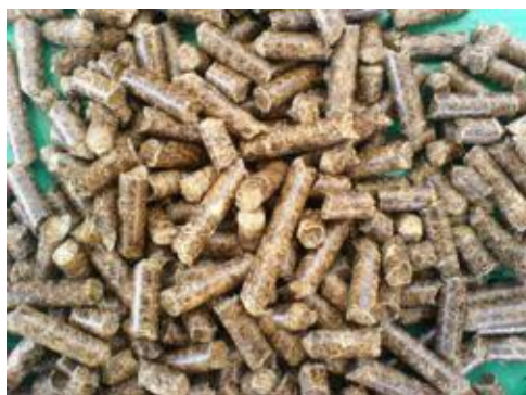
Εικόνα6.32: Μια μορφή βιομάζας: pellets (συσσωματώματα) τα οποία προκύπτουν από τη μηχανική συμπίεση πριονιδιού, χωρίς την προσθήκη χημικών ή συγκολλητικών ουσιών.
