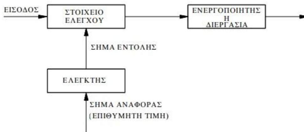
Σύστημα ανοικτού βρόχου. Σχήμα 1 .
