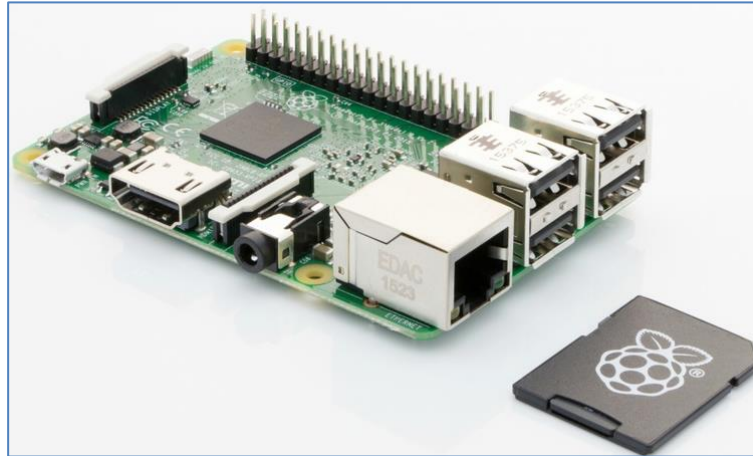
Εικόνα 1.1: Raspberry Pi Generation 3 Model B και κάρτα microSD
