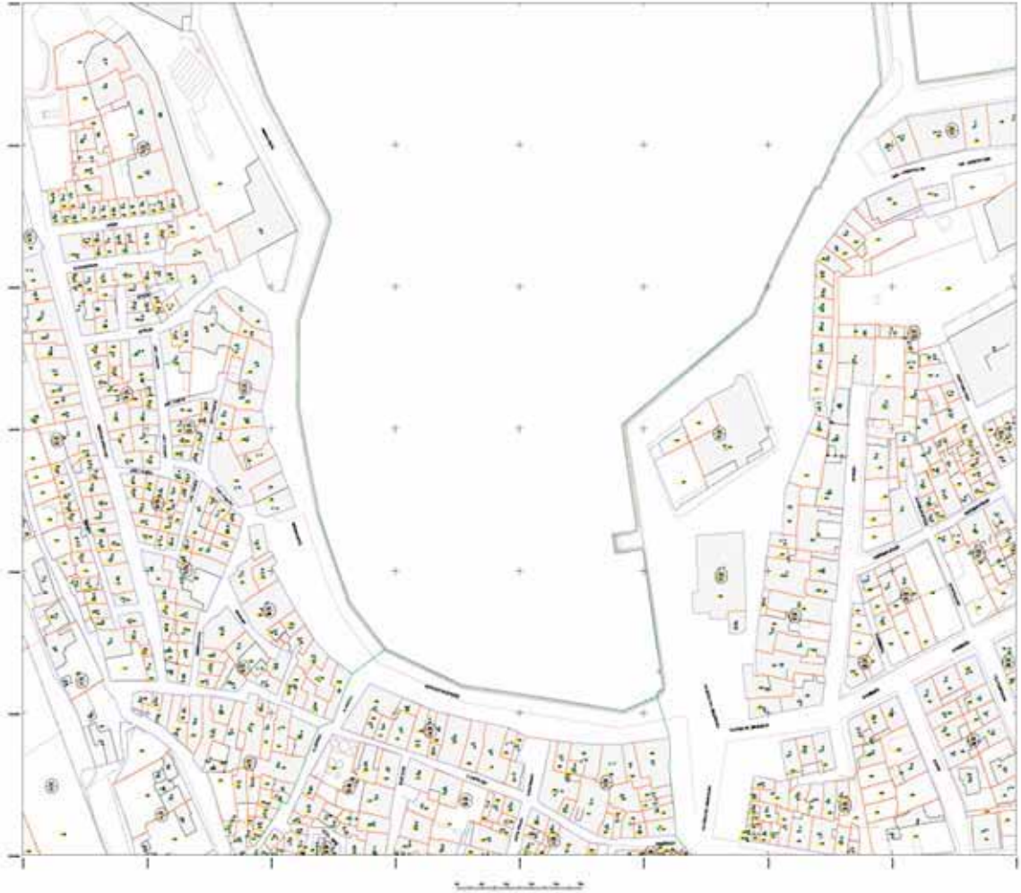
Σχ. 5.5. Τοπογραφικό διάγραμμα που σχεδιάστηκε με τη βοήθεια Η/Υ και σχεδιογράφου
