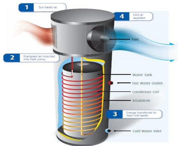
Σχήμα 2.3: Αντλία θερμότητας νερού χρήσης.[76]
