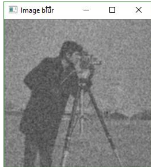
Εικόνα 2.41: Εικόνα μετά την χρήση του φίλτρου αριθμητικής μέσης τιμής.
