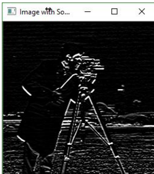
Εικόνα 2.33: Οριζόντιες ακμές με το φίλτρο κάθετης πρώτης παραγώγου.
