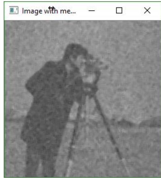
Εικόνα 2.45: Εικόνα μετά την χρήση του φίλτρου μεσαίας τιμής.
