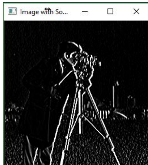
Εικόνα 2.34: Κάθετες ακμές με το φίλτρο οριζόντιας πρώτης παραγώγου.
