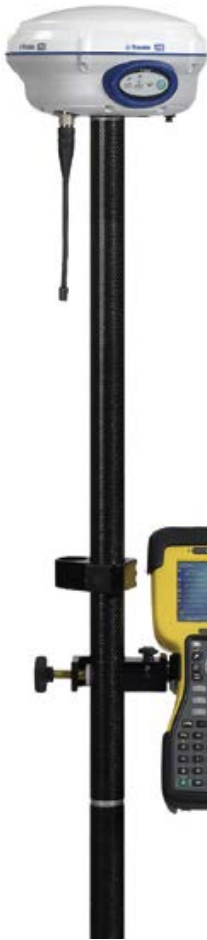
Εικόνα 3.2: Δέκτης διπλής συχνότητας παγκοσμίου συστήματος αναφοράς (GPS) Trimble R4
