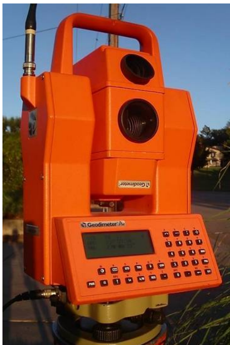
Εικόνα 3.1: Ηλεκτρονικός ενιαίος ολοκληρωμένος σερβοκινούμενος γεωδαιτικός σταθμός, Geodimeter 610 S Pro 10cc
