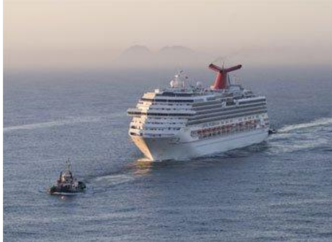
Εικόνα 2.11: Κρουαζιερόπλοιο «Carnival Splendor» ρυμουλκείται προς επισκευή μετά από έκρηξη νέφους ελαίου στροφαλοθάλαμου, σε μια κύρια μηχανή [19].
