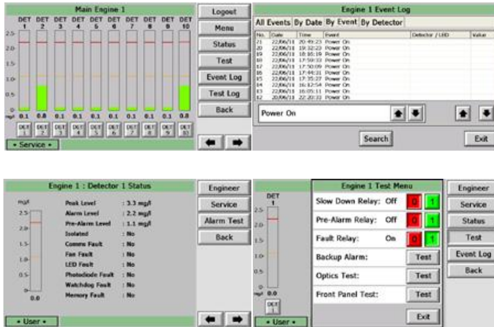
Εικόνα 3.13: Ενδείξεις κεντρικής μονάδας Graviner Mk 7 OMD [10].
