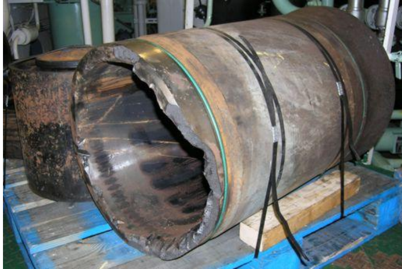
Εικόνα 2.7: Κατεστραμμένο χιτώνιο εμβόλου, κύριας μηχανής πλοίου, τύπου Sulzer ZA40 [23].
