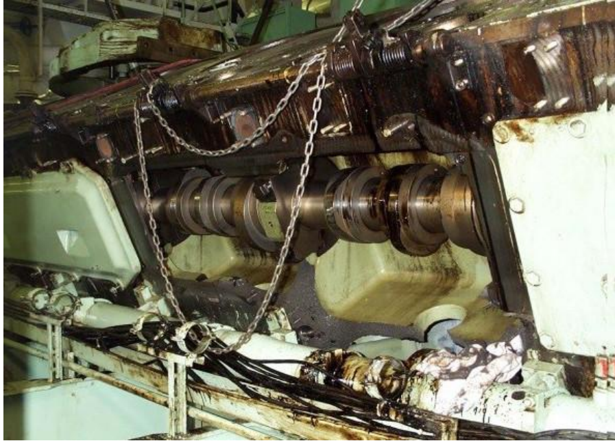
Εικόνα 1.3: Κύρια μηχανή πλοίου μετά από έκρηξη νέφους ελαίου στο στροφαλοθάλαμο [23].
