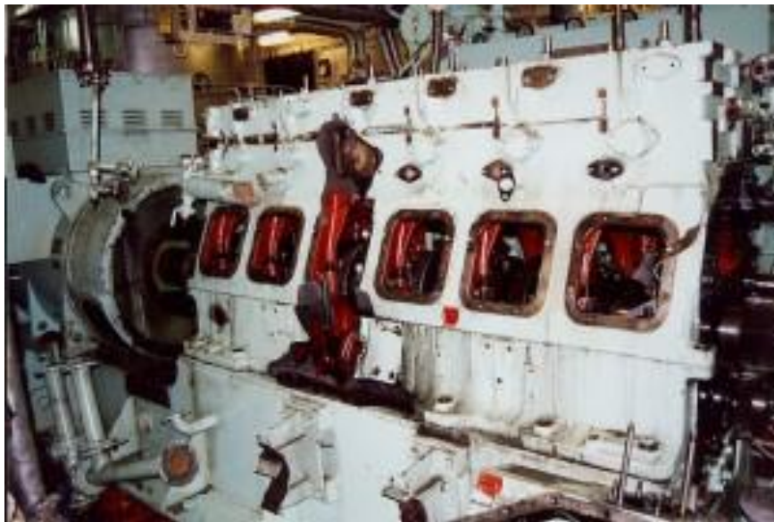
Εικόνα 2.9: Κύρια μηχανή πλοίου μετά από έκρηξη νέφους ελαίου στροφαλοθαλάμου [15].
