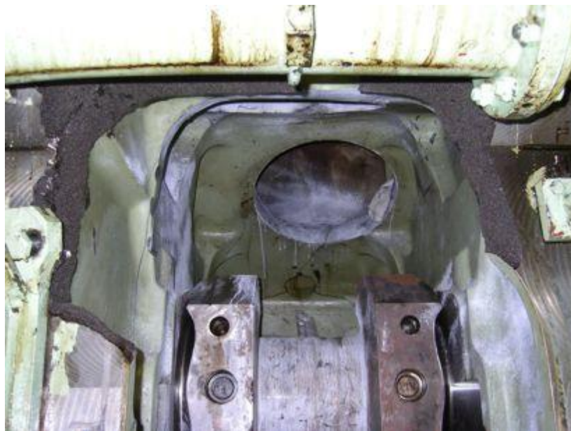
Εικόνα 2.6: Κατεστραμμένος κορμός (block), κύριας μηχανής πλοίου, τύπου Sulzer ZA40 [23].
