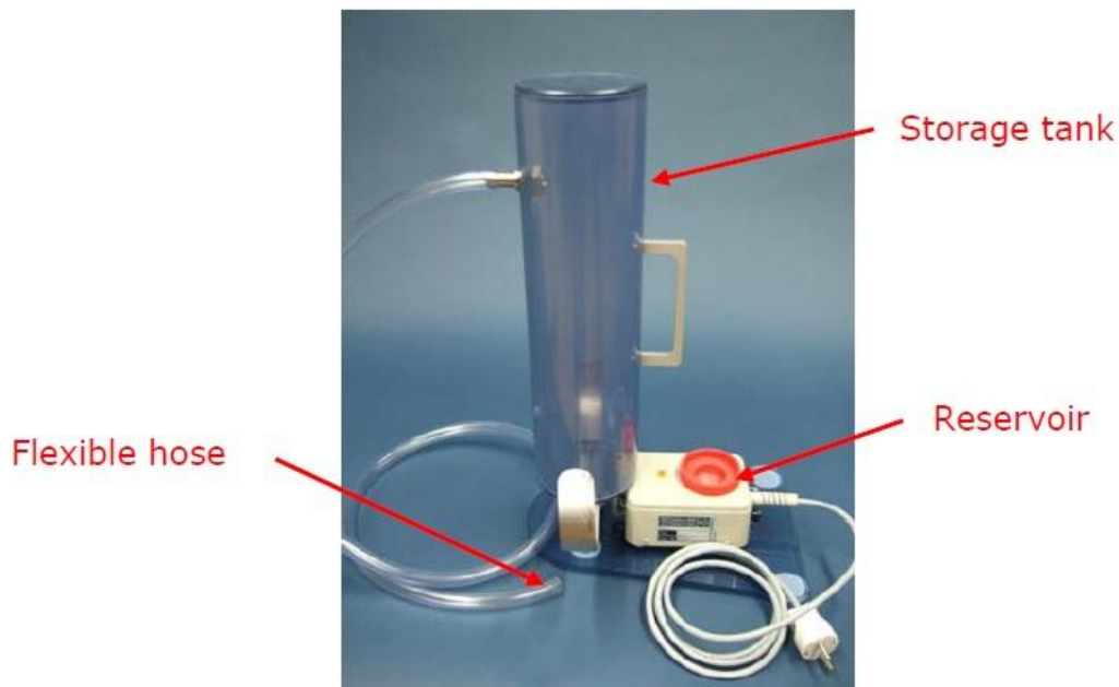
Εικόνα 3.9: Γεννήτρια παραγωγής νέφους ελαίου για την πραγματοποίηση δοκιμών σε συστήματα ανίχνευσης VISATRON [7].
