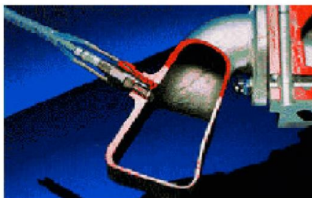
Σχήμα 4.10: Αισθητήρας μέτρησης απόλυτης πίεσης στην πολλαπλή εισαγωγή αέρα
