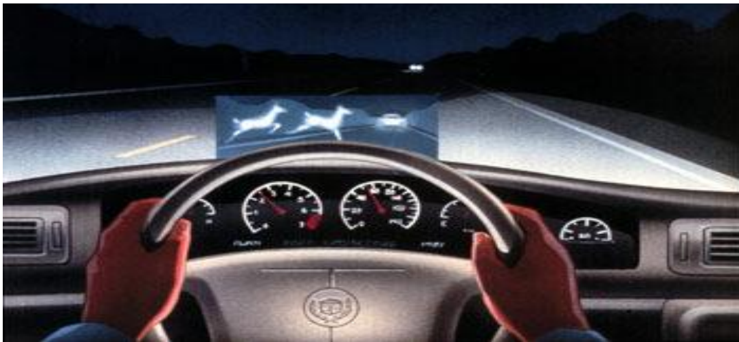
Σχήμα 5.2: Σύστημα προειδοποίησης οδηγού μέσω υπέρυθρων αισθητήρων
