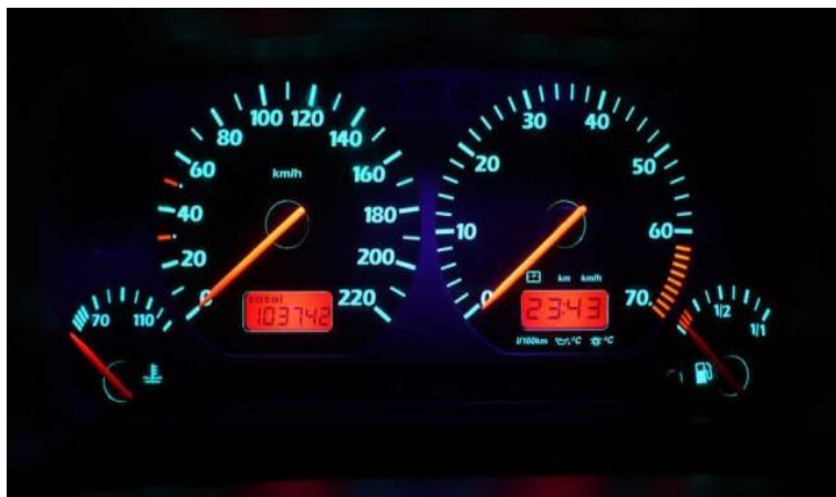
Σχήμα 3.4: Καντράν Αυτοκινήτου με δείκτες διάφορων αισθητήρων όπως ταχύτητας, ροπής, απόστασης, στάθμης, θερμοκρασίας
