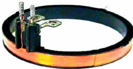
Σχήμα 4.21: Μαγνητικός Δακτύλιος χρησιμοποιούμενος σε ABS
