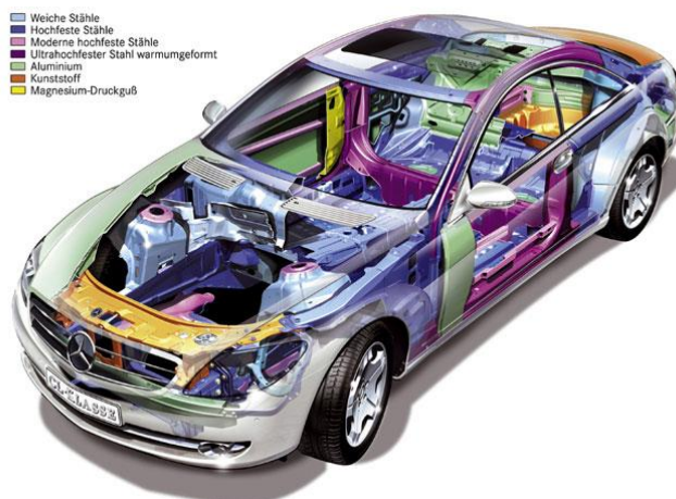
Σχήμα 2.3: Πλαίσιο Αυτοκινήτου με τα διαφορετικά υλικά ανά χρώμα
