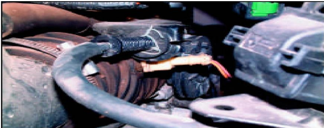
Σχήμα 4.4: Αισθητήρας Θερμοκρασίας Εισερχόμενου Αέρα στην πολλαπλή εισαγωγή
