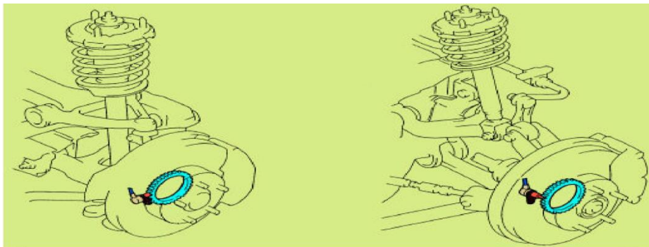
Σχήμα 4.19: Μαγνητικός αισθητήρας στροφών σε σύστημα ABS
