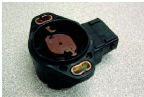
Σχήμα 4.18: Αισθητήρας ταχύτητας στροφών φαινομένου Hall
