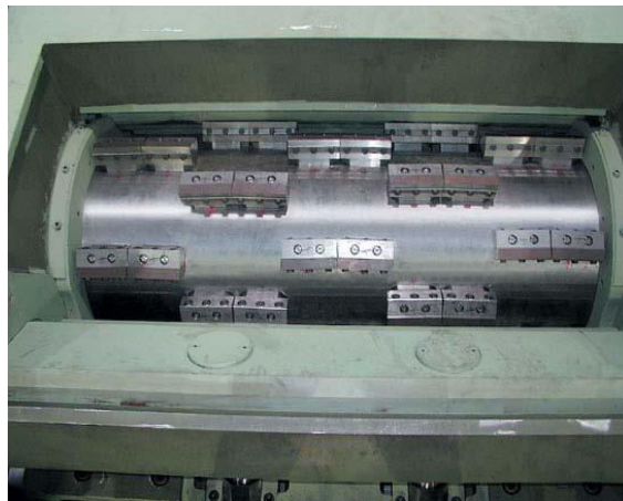
Εικόνα 3: Κοκκοποιητής: Η θέση του είναι μετά τον τεμαχιστή και σκοπό έχει να μειώνει αισθητά το μέγεθος των κόκκων
