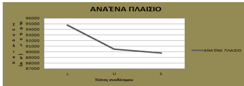
Εικόνα 79 σύγκριση συνολικού βάρους ανάλογα με το τύπο συνδέσμου
