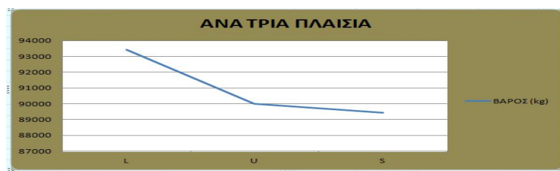
Εικόνα 81 σύγκριση βάρους ανάλογα με τον τύπο συνδεσμου
