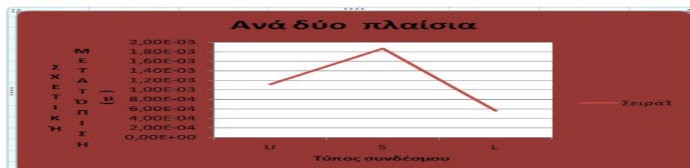
Εικόνα 100 Σχετική μετατόπιση βάση το σύνδεσμο δυσκαμψίας
