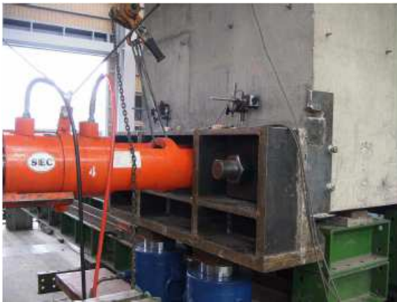
Εικόνα 31 Εργαστηριακός έλεγχος προσωρινής στήριξης με προεντεταμένους τένοντες [35]
