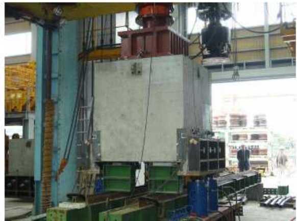
Εικόνα 31 Εργαστηριακός έλεγχος προσωρινής στήριξης με προεντεταμένους τένοντες [35]
