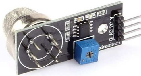
Εικόνα 2.4.3: Αισθητήρας ποιότητας αέρα MQ135
