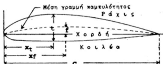
Σχήμα 11. Γεωμετρία της αεροτομής
