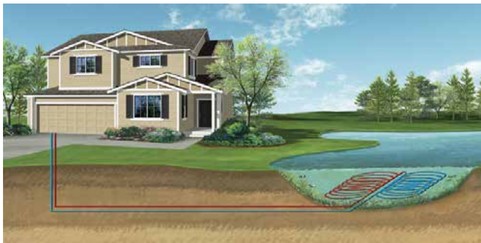
Εικόνα 3.7: Σύστημα γεωθερμίας http// fotoltaika.gr
