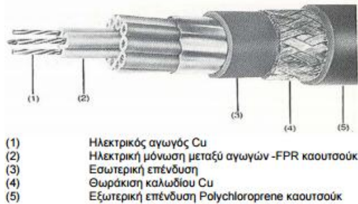
Τυπική δομή καλωδίων ναυτικού τύπου
