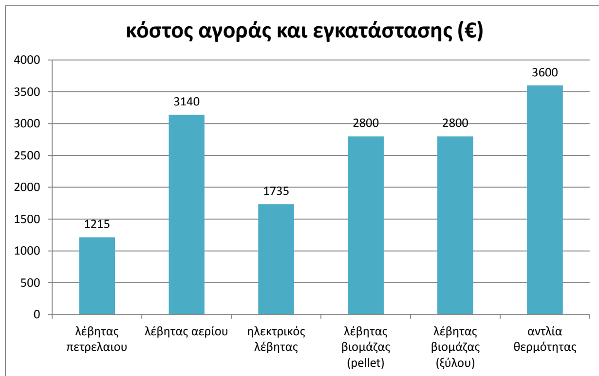
Σχήμα 6.1:Κόστη τεχνολογιών θέρμανσης
