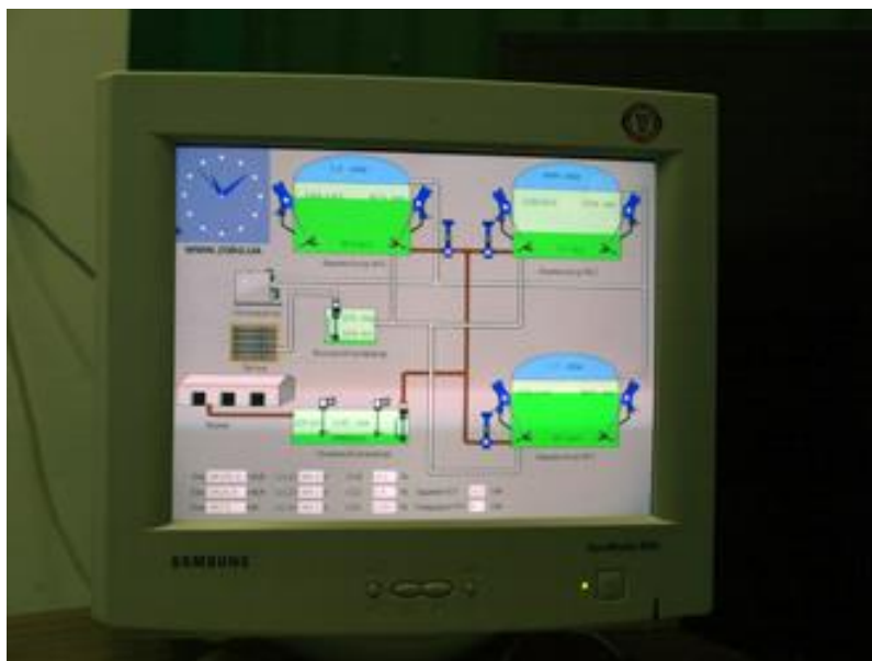
Εικόνα 4.11. Απεικόνιση αυτόματου συστήματος παρακολούθησης μονάδας βιοαερίου.
