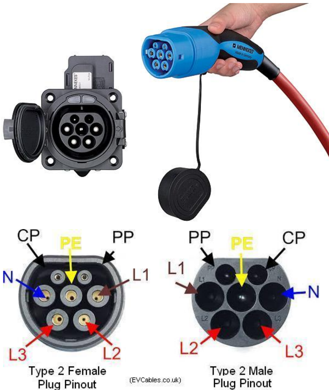
Εικόνα 6.16. Βύσμα Τύπος 2 (VDE-AR-E-2623-2-2), Mennekes και χαρακτηριστικά ακροδεκτών.
