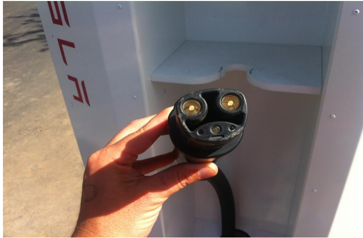
Εικόνα 6.21. Βύσμα Τύπου Tesla για τους υπερφορτιστές της ίδιας εταιρίας.
