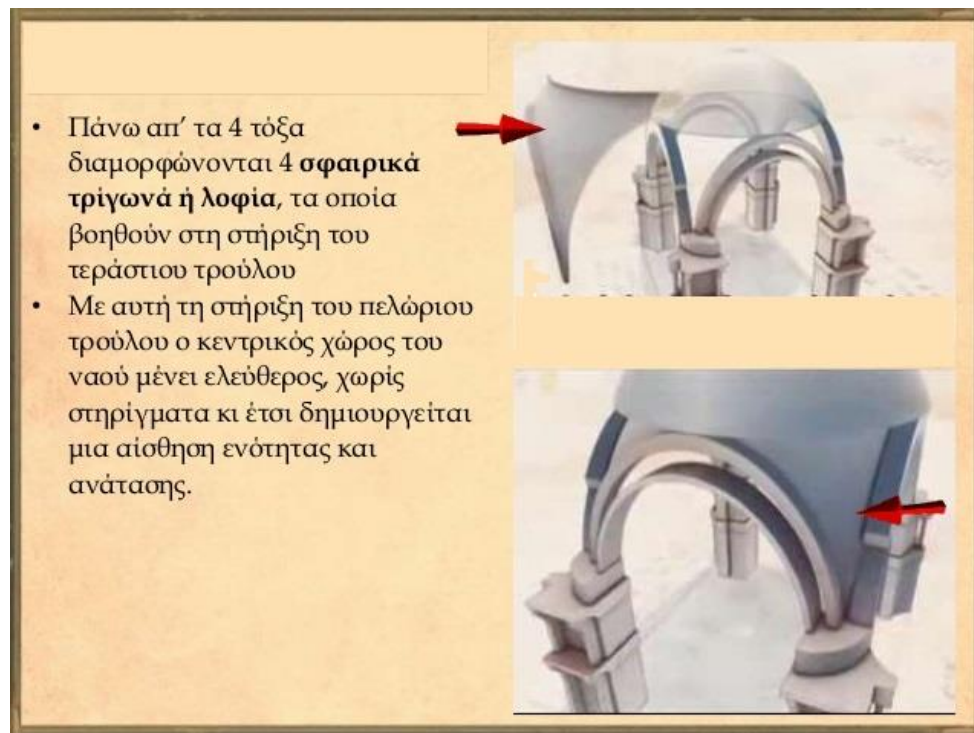
Εικ. 4: Μέθοδος στήριξης τύμπανου στη τετραγωνική βάση
