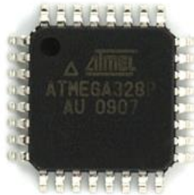
Εικόνα 2.6: Ο μικροεπεξεργαστής ATmega328 σε τύπο SMD
