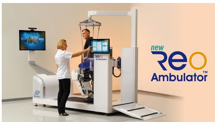
Εικόνα 2.1 Ρομποτικό Σύστημα Υποβοήθησης Κάτω Άκρων REOAMBULATOR
