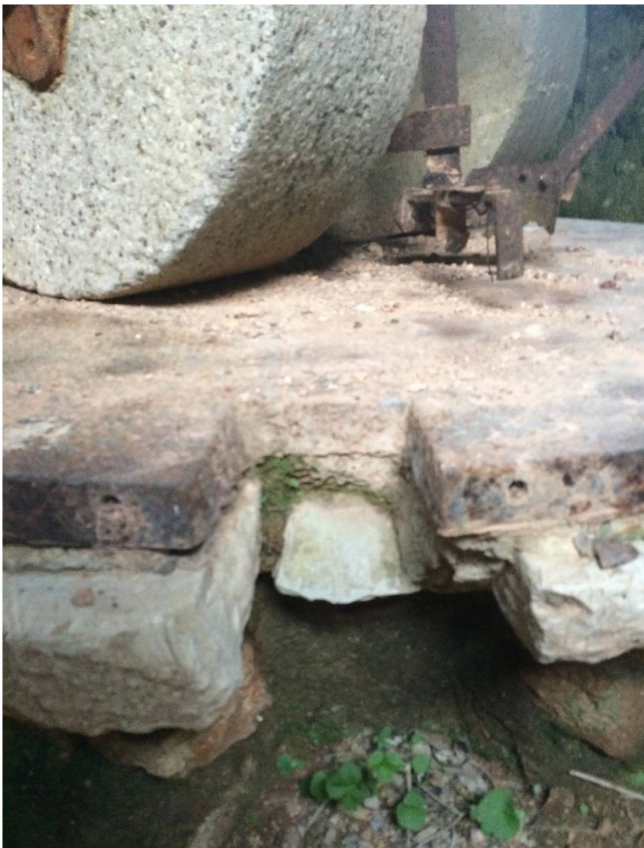
Εικόνα 3.99 Ελαιόμυλος, το κενό υπήρχε για να βγαίνει ο πολτός
