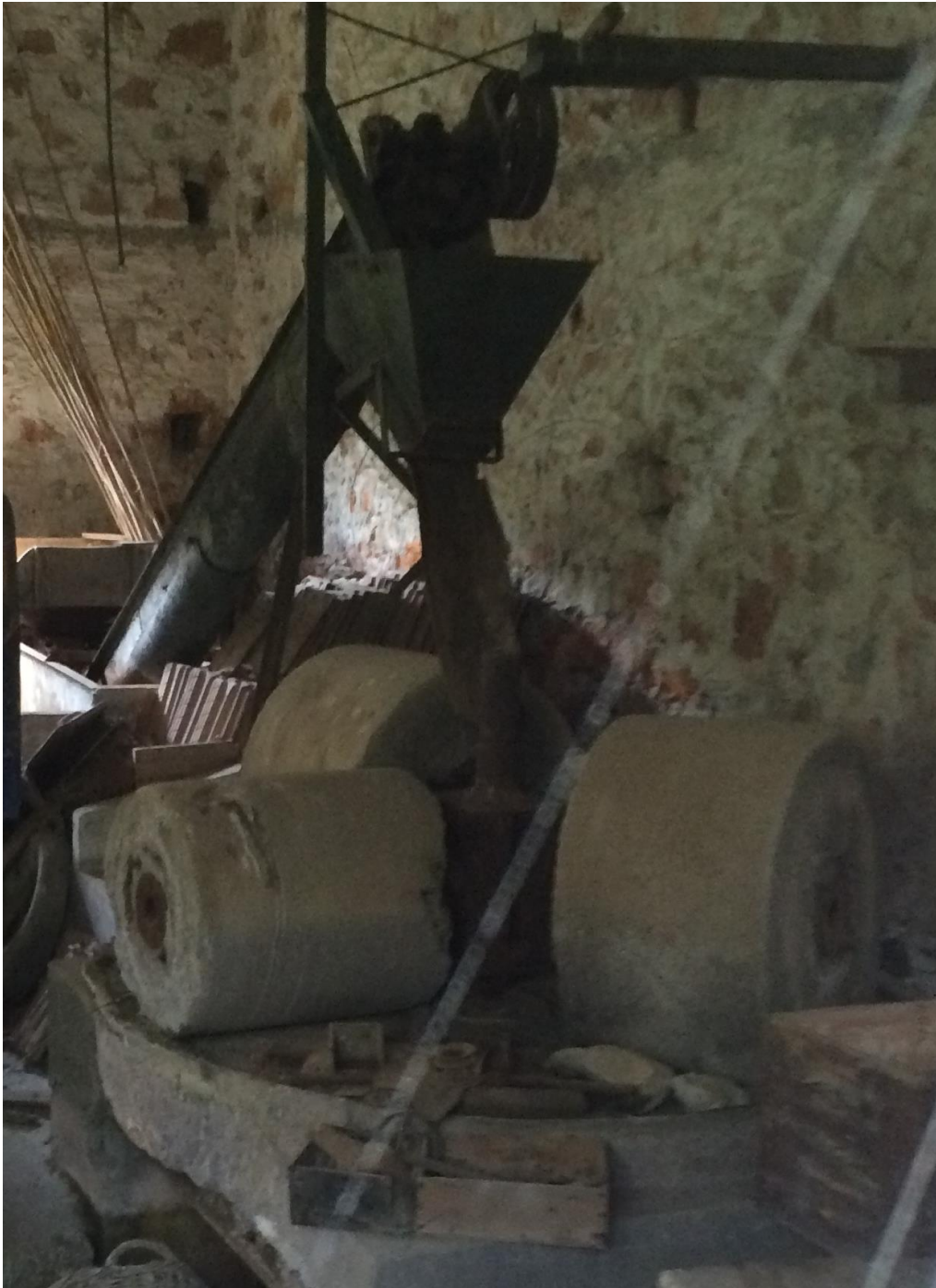
Εικόνα 3.78 Ο ελαιόμυλος, όπου ξεχωρίζει η ύπαρξη τριών μυλόπετρων, καθώς και το αναβατήριο
