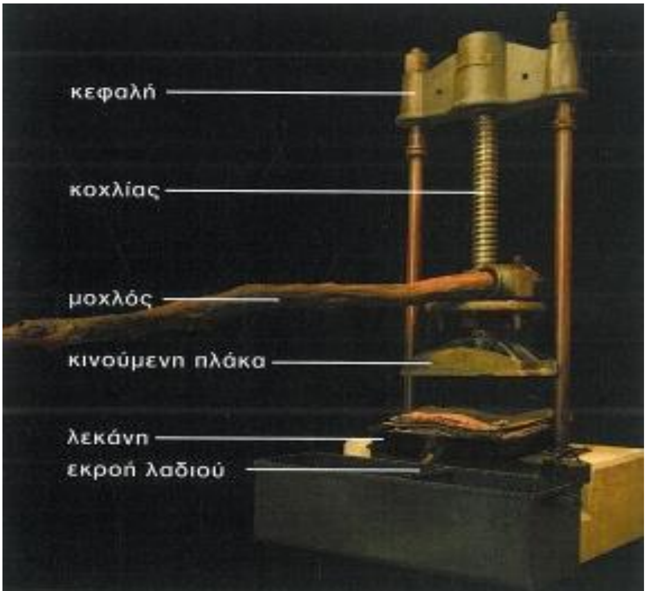
Εικόνα 3.4 Πιεστήριο και οι λειτουργίες του
