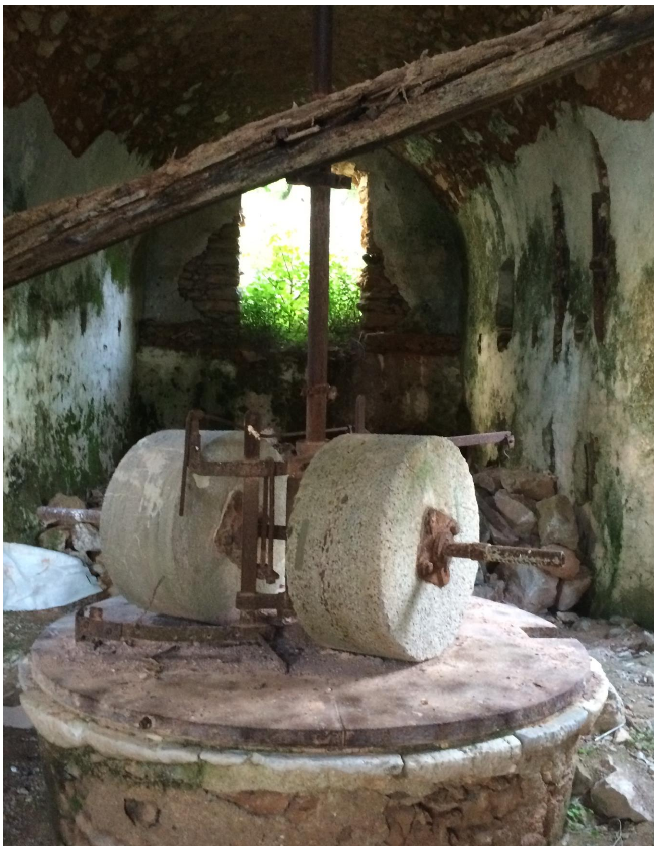
Εικόνα 3.3 Ελαιόμυλος στην Κάτω Χώρα (της οικογένειας Φωτεινού), όπου διακρίνονται οι πέτρες που περιστρέφονταν κατά 360 μοίρες καθώς και το ξύλο που βοήθησε στην περιστροφή τους
