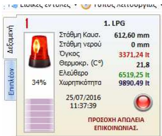
Εικ. 4.7.2: Ένδειξη ειδοποίησης σε περίπτωση απώλειας επικοινωνίας με την δεξαμενή
