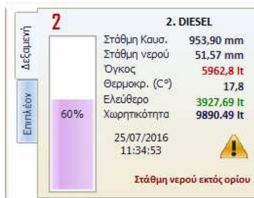
Εικ. 4.7.3: Ένδειξη ειδοποίησης σε περίπτωση ύπαρξης νερού εντός της δεξαμενής
