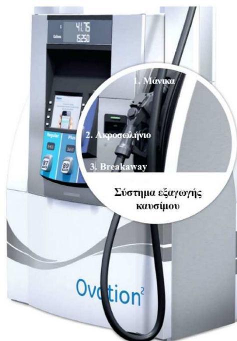
Εικ. 3.3.5: Σύστημα εξαγωγής καυσίμου διανομέα Wayne
