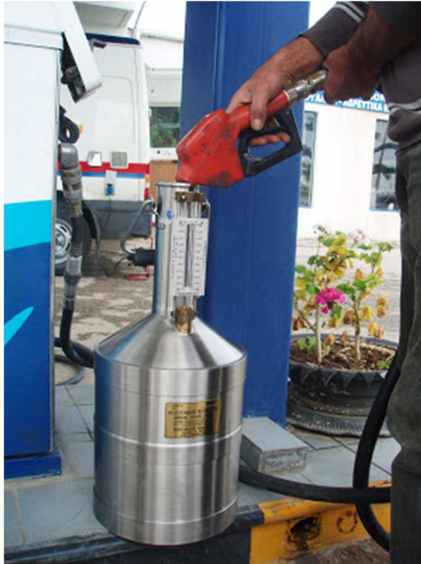
Εικ. 4.3.3: Απεικόνιση διαδικασίας λιτρομέτρησης αντλίας σε πρατήριο υγρών καυσίμων
