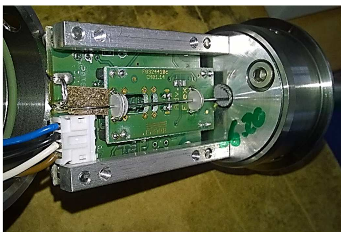
Εικ. 3.6.3: Μπροστινή όψη ηλεκτρονικού κυκλώματος κεφαλής αισθητήρα Fafnir
