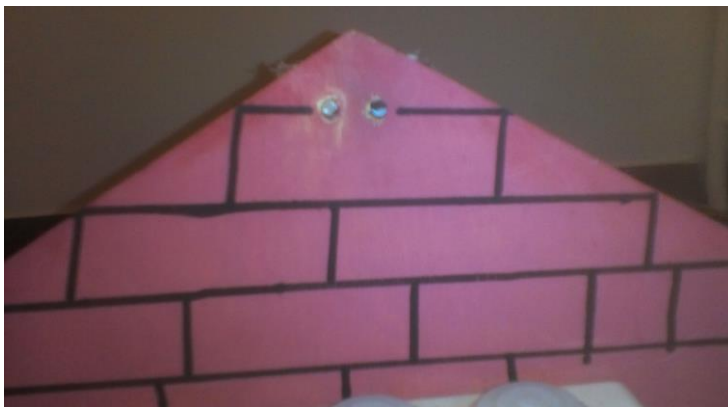
Αισθητήρια θερμοκρασίας και φωτός
