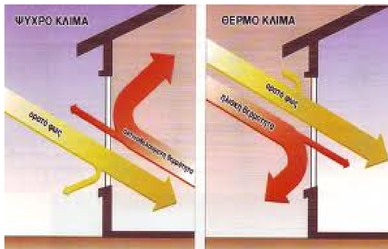
2.2 Λειτουργία ενεργειακού υαλοπίνακα
