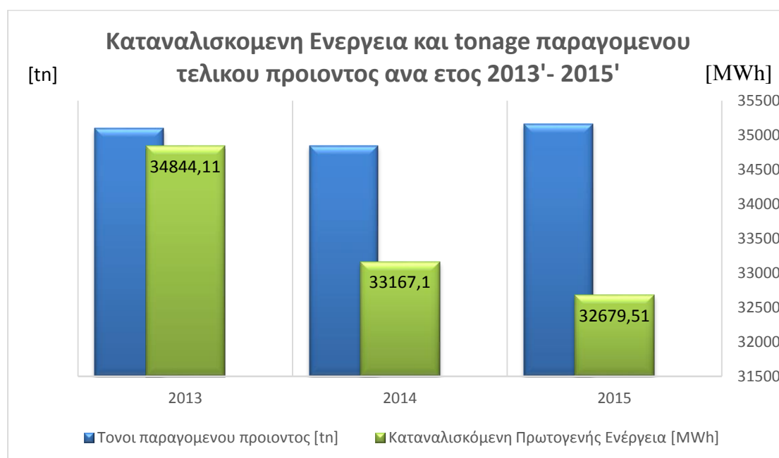
Γράφημα 3.3.4.1 Καταναλισκόμενη Πρωτογενής Ενέργεια και tonnage παραγόμενου τελικού προϊόντος ανά έτος 2013'- 2015' (Ο άξονας αφαιρέθηκε λόγω ευαίσθητων δεδομένων της εταιρίας)
