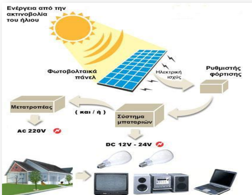
Εικόνα 1: Απεικόνιση κύκλου εργασιών ενός αυτόνομου φωτοβολταϊκού συστήματος
