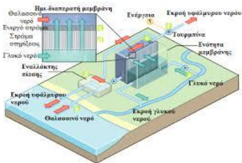
Εικόνα 8: Παραγωγή ηλεκτρικής ενέργειας με τη μέθοδο PRO
