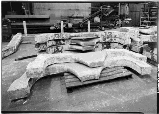
Διάφραγμα από F-15 πριν και μετά το πρεσάρισμα σε πρέσα 50000 ton
