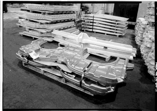
Διάφραγμα από F-15 πριν και μετά το πρεσάρισμα σε πρέσα 50000 ton
