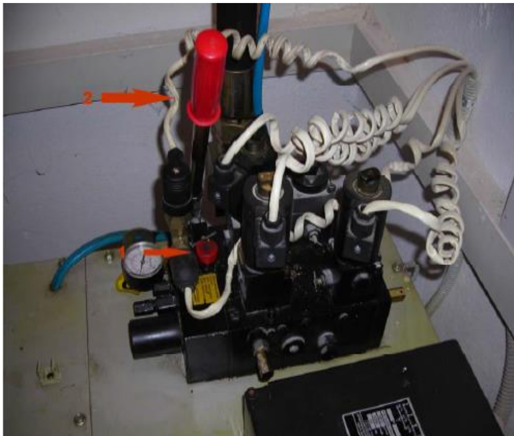
Εικόνα 6.18: 1) Κόκκινο κουμπί εκτόνωσης λαδιού, 2) Μοχλός πρεσσαρίσματος
