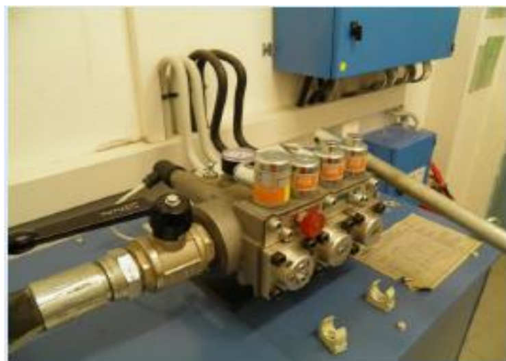
Εικόνα 6.16: Κινητήριος μηχανισμός υδραυλικού ανελκυστήρα
