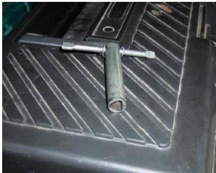
Εικόνα 6.6: Τρίγωνο κλειδί ανεγκυστήρων
