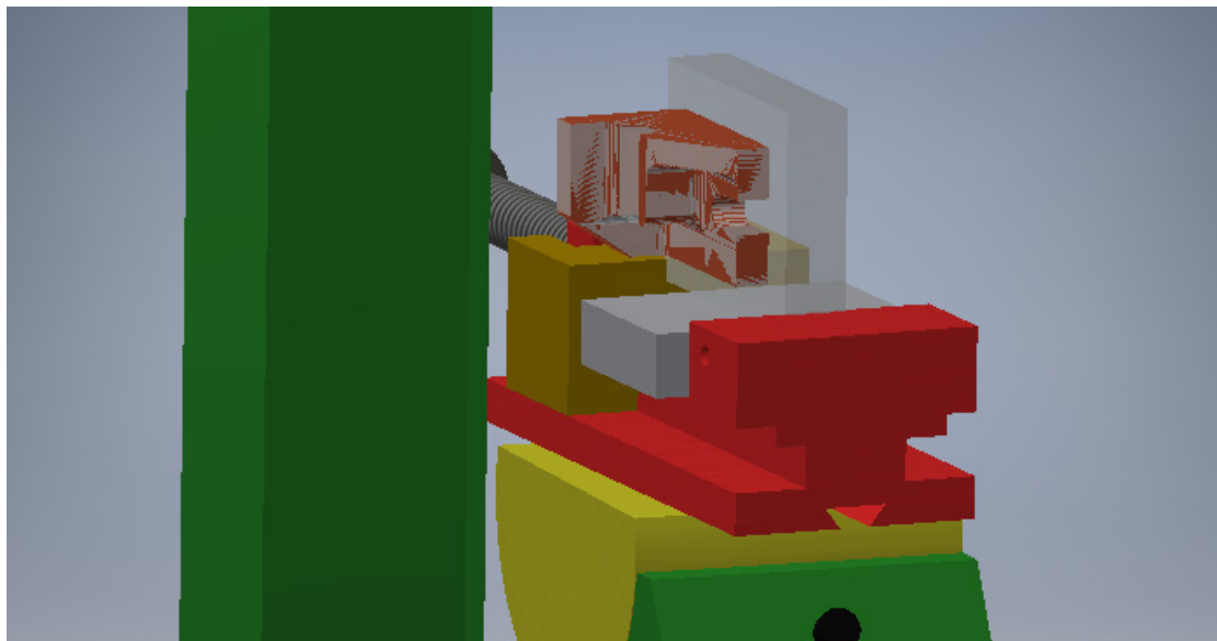
Σχέδιο 91 : Τοποθέτηση μέγγενης στην αρχική της θέση και περιστροφή 90 μοιρών του δοκιμίου
