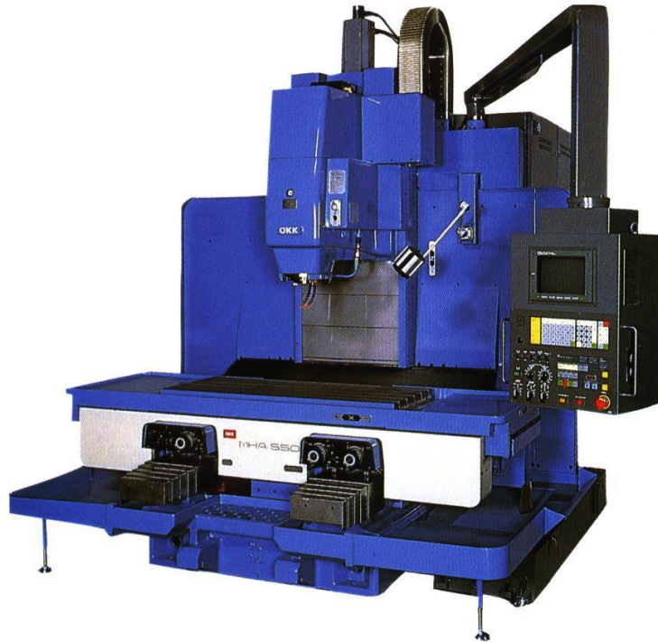
Σχήμα 1.7. CNC φρέζα 3 αξόνων. Παρατηρείστε ότι δεν υπάρχει εργαλειοθήκη για την αυτόματη αλλαγή των εργαλείων, σε αντίθεση με τα κέντρα κατεργασίας που διαθέτουν εργαλειοθήκη για την αποθήκευση και ανά πάσα στιγμή χρησιμοποίηση διαφόρων τύπων εργαλείων, όπως τρυπάνια, κολαούζα κλπ. (MHA550). (Courtesy of OKK Corporation Japan).
