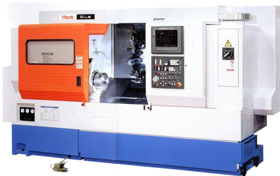
Σχήμα 1.9. CNC τόνος 2 αξόνων. Ο τόνος διαθέτει μία άτρακτο και ένα εργαλειοφορείο χωρίς να έχει τη δυνατότητα χρησιμοποίησης αυτοκινούμενων εργαλείων στο εργαλειοφορείο για κατεργασίες φρεζαρίσματος. (MAZAK SQT 28.). (Courtesy of Yamazaki Machinery UK Ltd., Worcester, UK.).
