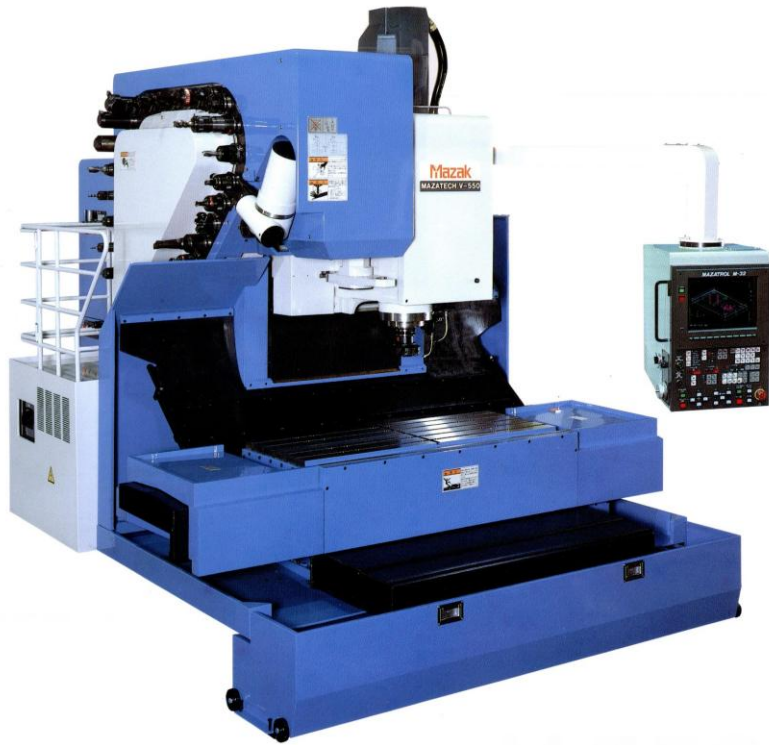
Σχήμα 1.8. Κέντρο κατεργασίας CNC 3 αξόνων. (MAZAK MAZATECH V-550.). (Courtesy of Yamazaki Machinery UK Ltd., Worcester, UK.).
