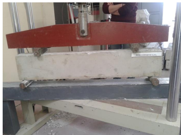
Εικόνα 19.2: Πειραματική διάταξη για δοκιμή κάμψης δοκού
