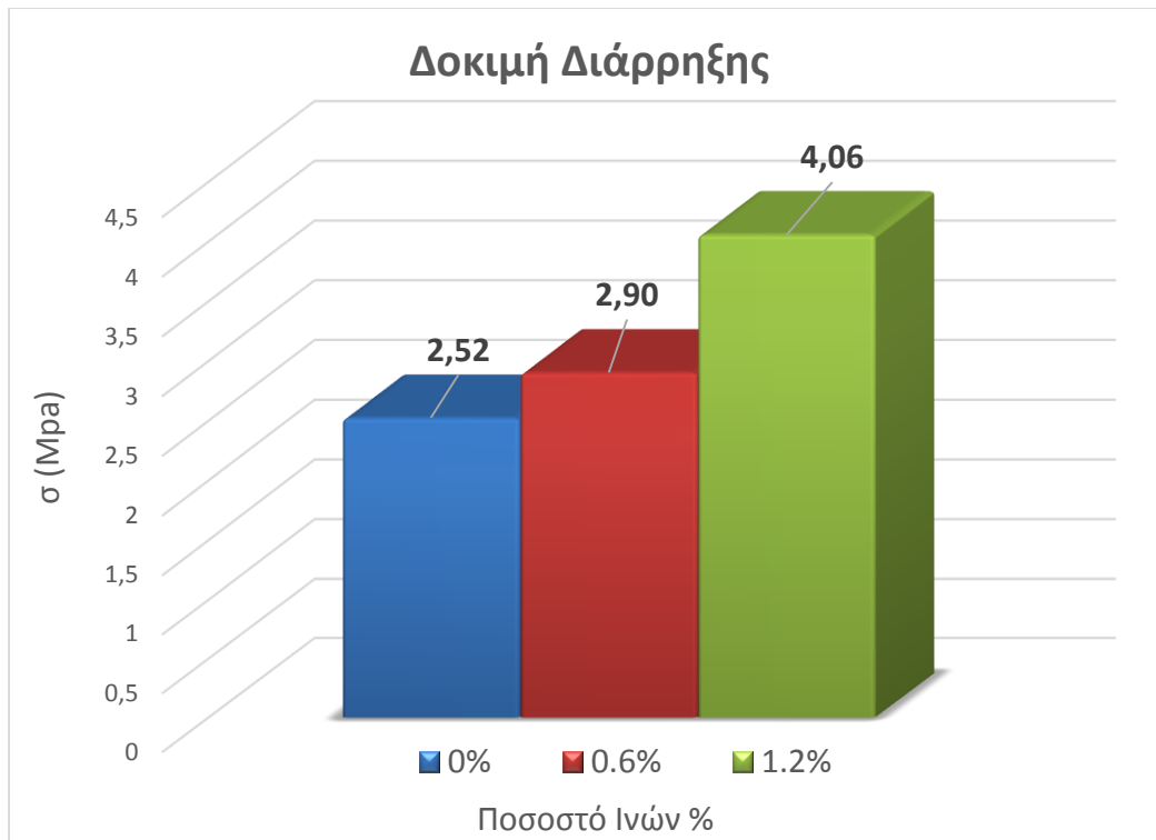
Διάγραμμα 25: Γενικό συγκριτικό διάγραμμα δοκιμής διάρρηξης, τάσης-ποσοστού ινών ( \sigma - v_f )
