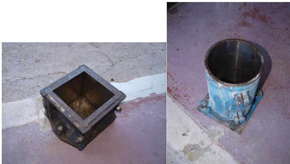
Εικόνα 14: Μήτρες σκυροδέτησης κυβικού και κυλινδρικού δοκιμίου
