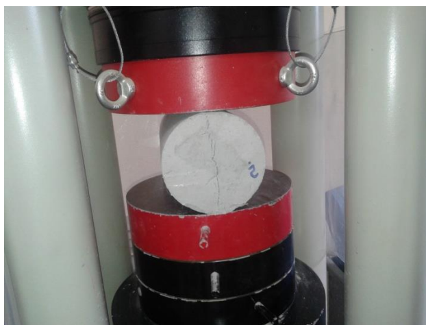
Εικόνα 18: Διάταξη δοκιμίου εντός μηχανής θλίψης για δοκιμή διάρρηξης
