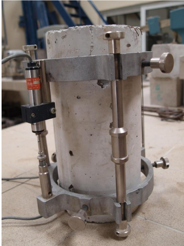
Εικόνα 25: Κύλινδρος έτοιμος για θλίψη, με την χρήση μηχανοστόμετρου καταγράφεται η βραχυνση
