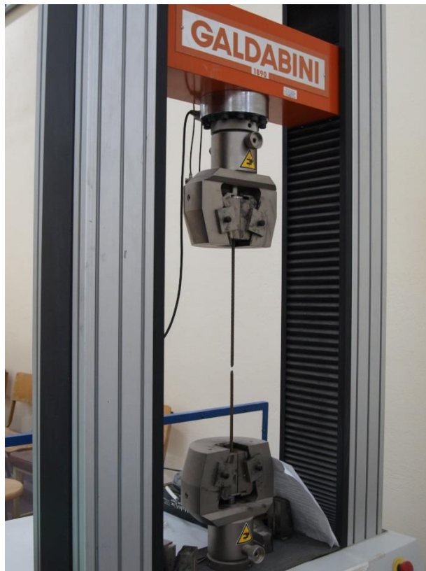
Εικόνα 26: Μηχανή εφελκυσμού ράβδων χάλυβα
