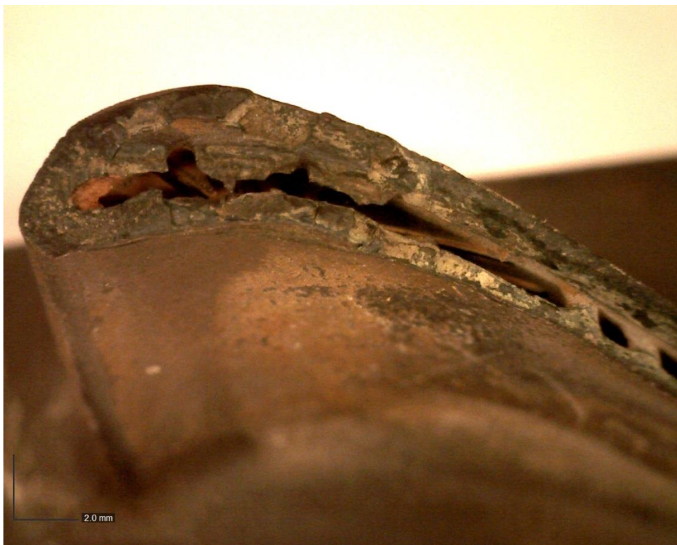
Εικ.24 Περιοχή έντονης διάβρωσης στο ακροπτερύγιο (tip)
