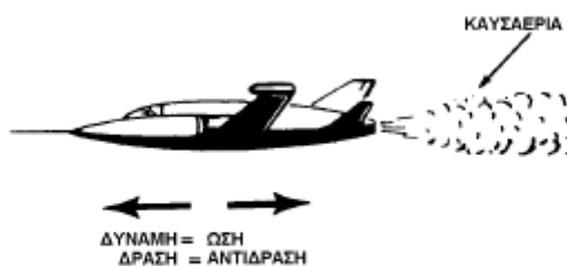
Εικ.2 Η δράση και η αντίδραση στην κίνηση του αεροσκάφους
