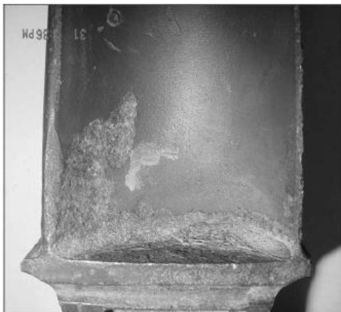
Εικ.1.4 Τράχυνση της επιφάνειας της βάσης και της πίσω ακμής, πλάτυνση της μπροστινής ακμής
