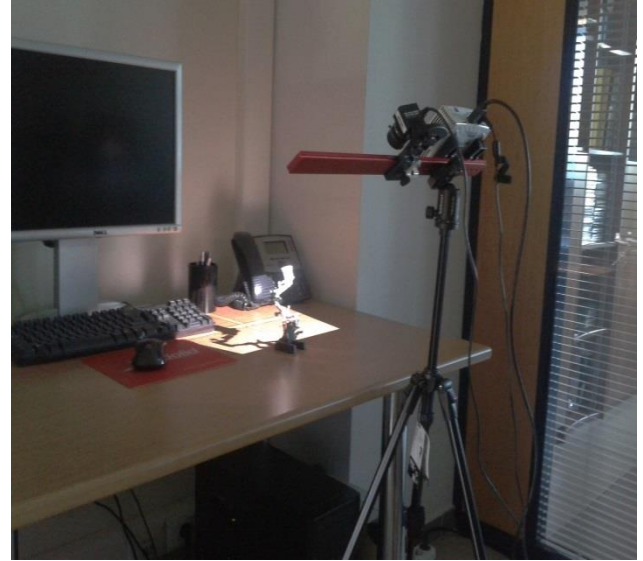
Εικ.4-5 Σκανάρισμα του περνεγίου
