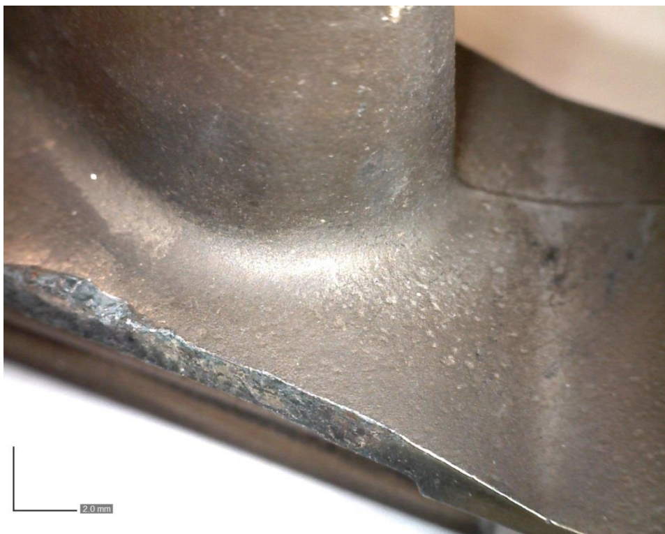
Εικ.26 Περιοχή μέγιστης μηχανικής καταπόνησης
