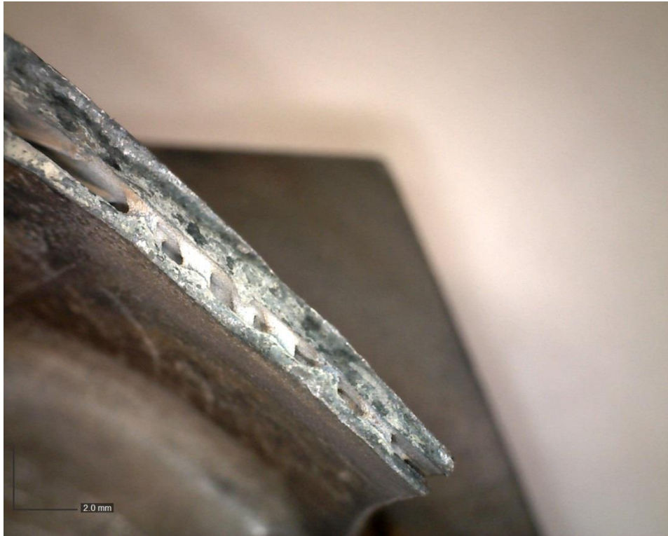
Εικ.29 Περιοχή με φαινόμενο πολυχρωματισμού επιφανείας (tip)
