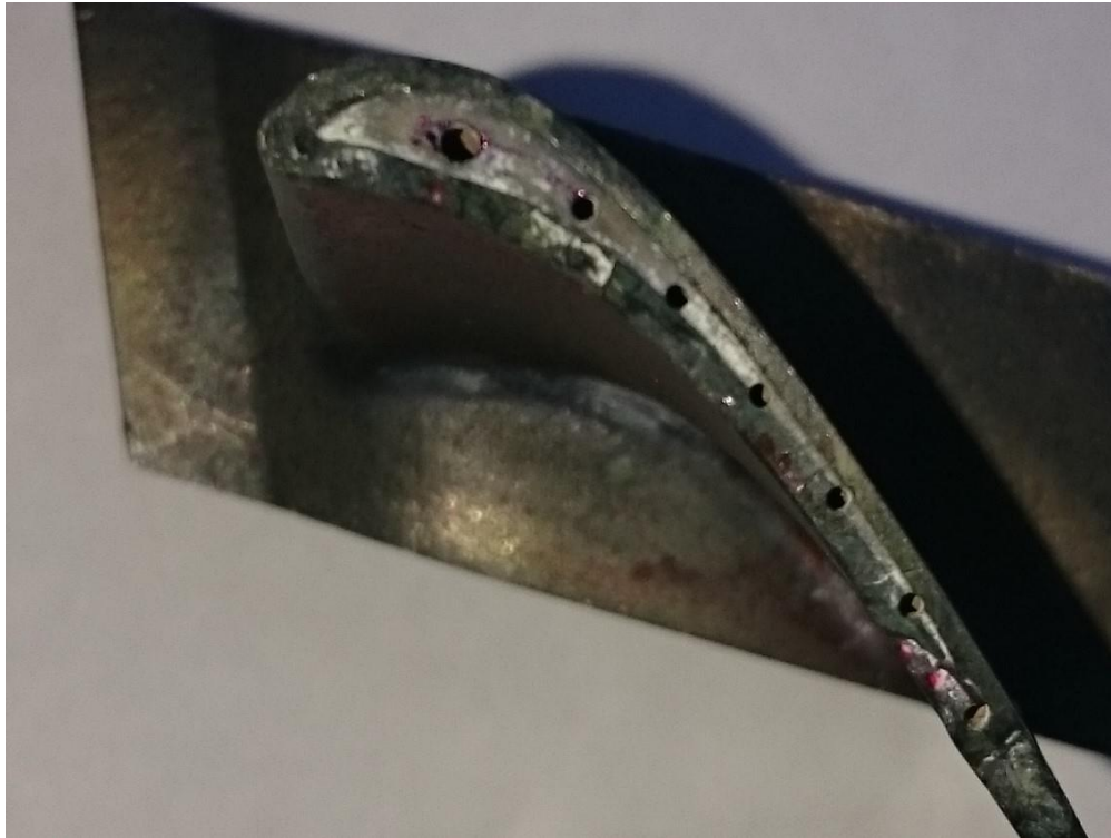
Εικ.23 Δίοδοι ψύξης πτερυγίου με μειωμένη φθορά
