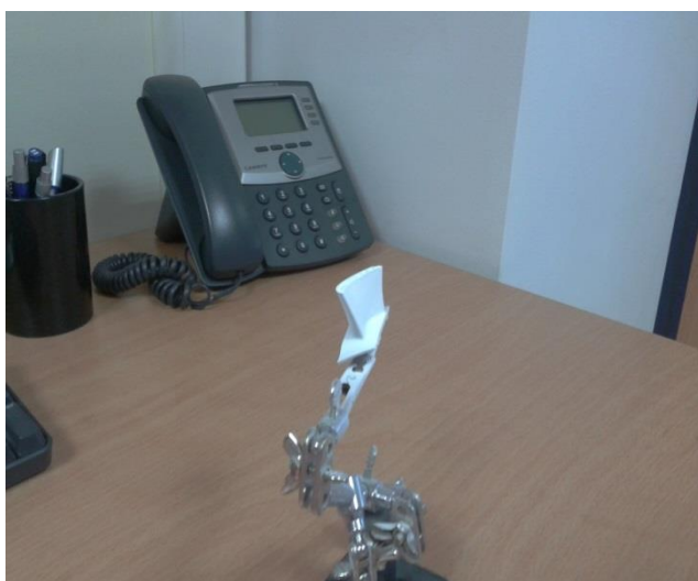
Εικ.2-3 Το πτερόγιο μετά από την τοποθέτηση της πούδρας κιμωλίας
