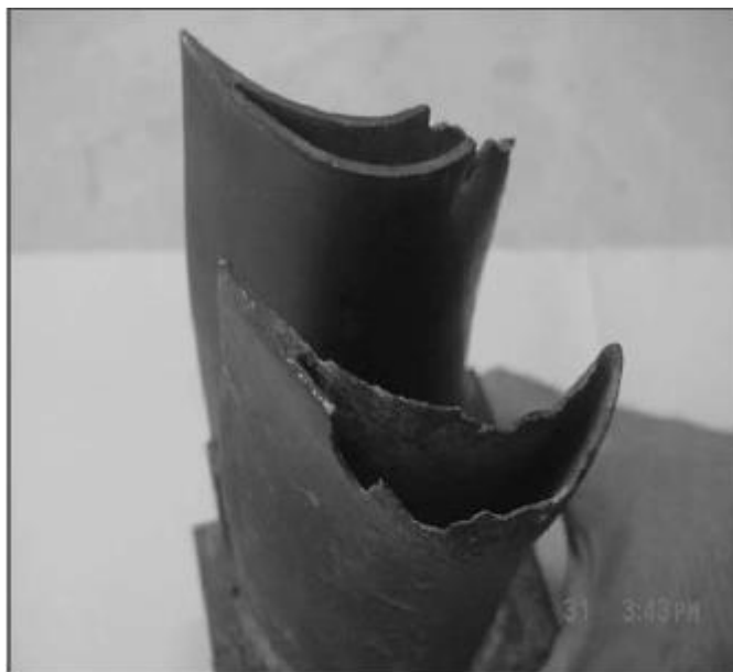
Εικ.1.3 Απώλεια υλικού στο ακροπτερύγιο
