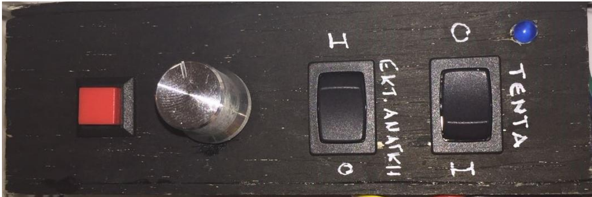
Εικόνα 167: Πάνελ ρύθμισης τέντας και ελέγχου διακόπτη έκτακτης ανάγκης
