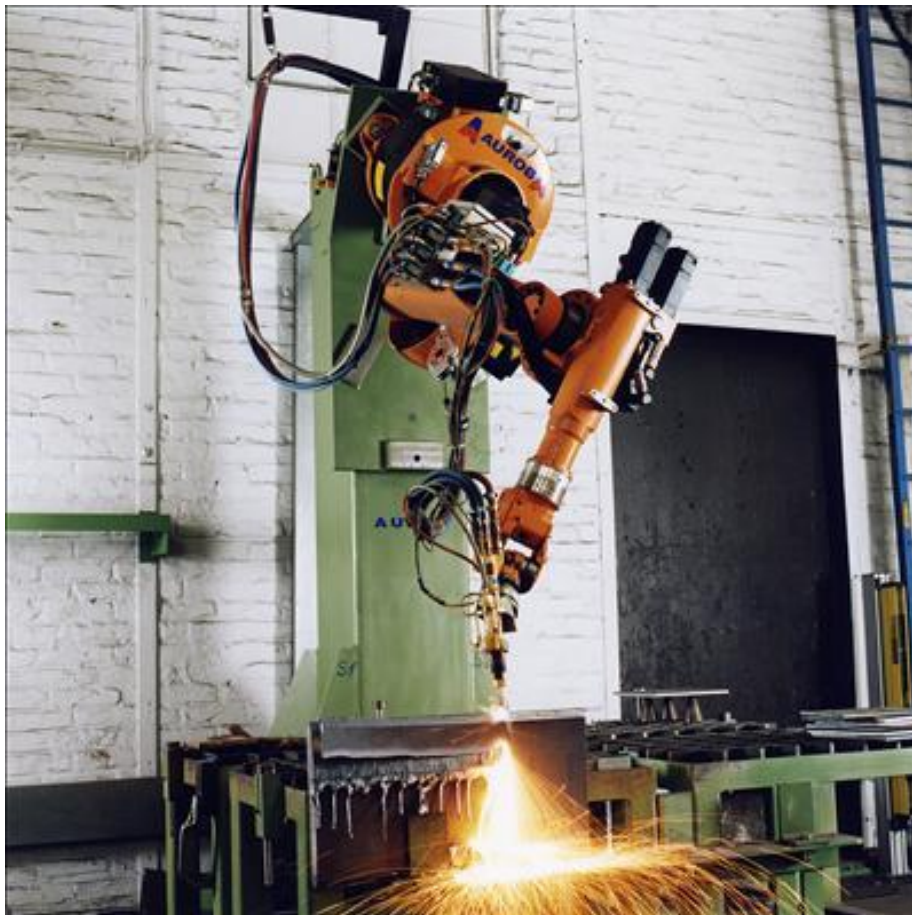
Εικόνα 1: Βιομηχανικό ρομπότ που κόβει κομμάτια ατσάλιού για τη κατασκευή μιας γέφυρας
