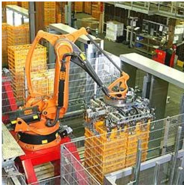
Εικόνα 3: Ρομπότ για την παλετοποίηση τροφίμων.
