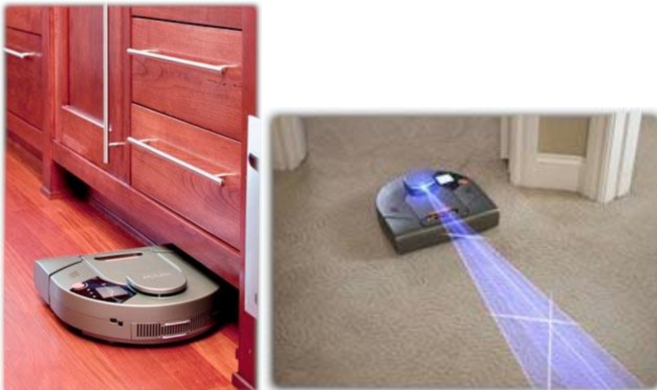
Εικόνα 4: Ρομπότ που καθαρίζει τους χώρους του σπιτιού και αποφεύγει τις προσκρούσεις
