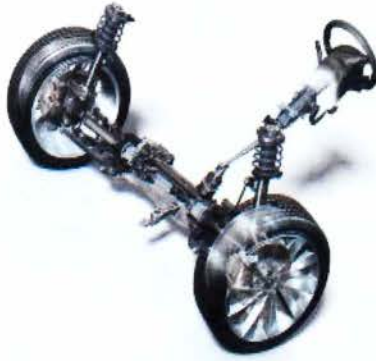
Το σύστημα διεύθυνσης του VWScirocco (ηλεκτρομηχανική υποβοήθηση)
