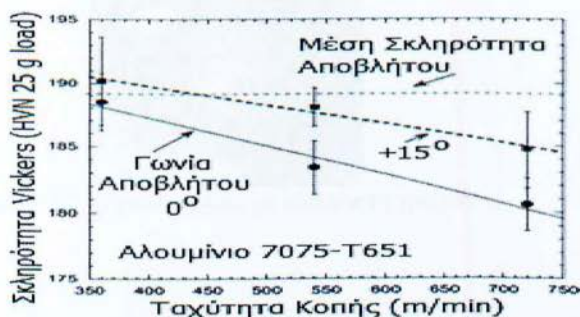
Σχήμα 3.7 Διάγραμμα μεταβολής της σκληρότητας του εργαλείου συνάρτησε της ταχυτήτας κοπής και της γωνίας του αποβλήτου.
