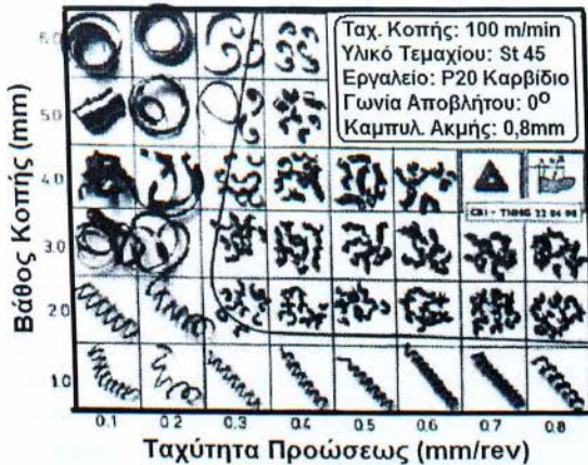
Σχήμα 3.5 Διάφορες μορφές αποβλήτων ανάλογα με την ταχύτητα προώσεως και το βάθος κοπής
