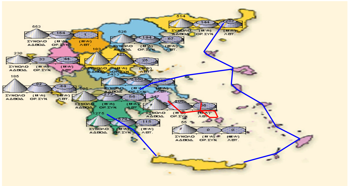
Σχήμα 20.1 Κατανομή της ισχύος Μονάδων ΑΠΕ του Συστήματος ως προς τη φάση ανάπτυξής τους, ανά Διοικητική Περιφέρεια και η σύνδεση του ΕΔΣΜ με αυτόνομα νησιώτικα συστήματα για τη μελετώμενη επέκταση των διασυνδέσεων των νησιών του Αιγαίου(—)
