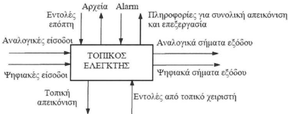
Σχ.2.8: Λειτουργικές Εντολές Τοπικού Ελεγκτή.
