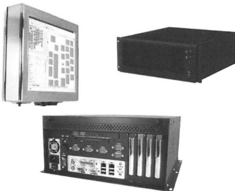
(πάνω αριστερά : Panel-PC / δεξιά: rackmount / κάτω : wallmount)
