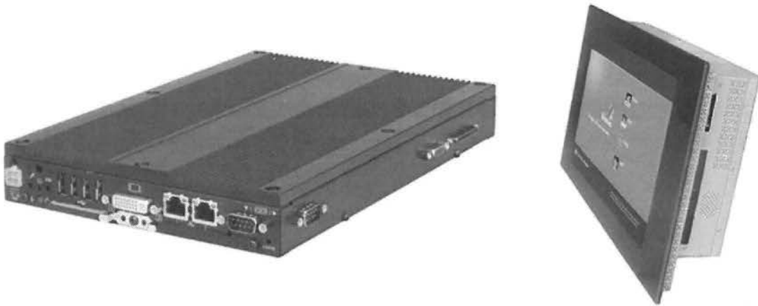
Σχ. 6.2: Παράδειγμα ενός EmbeddedPC(αριστερά) και ενός Panel-PC(δεξιά)
