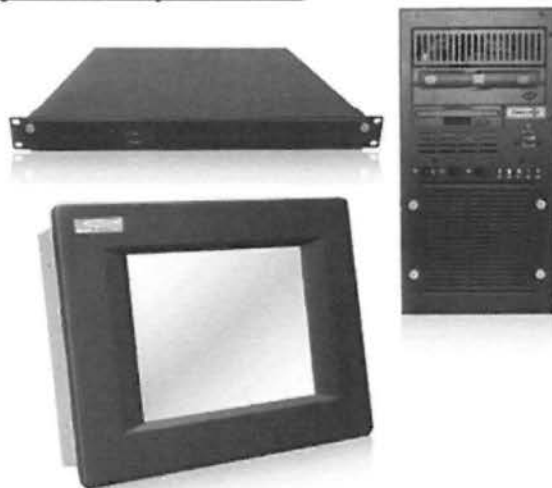
(πάνω αριστερά: rackmount / κάτω αριστερά: Panel-PC / δεξιά: Desktop)
