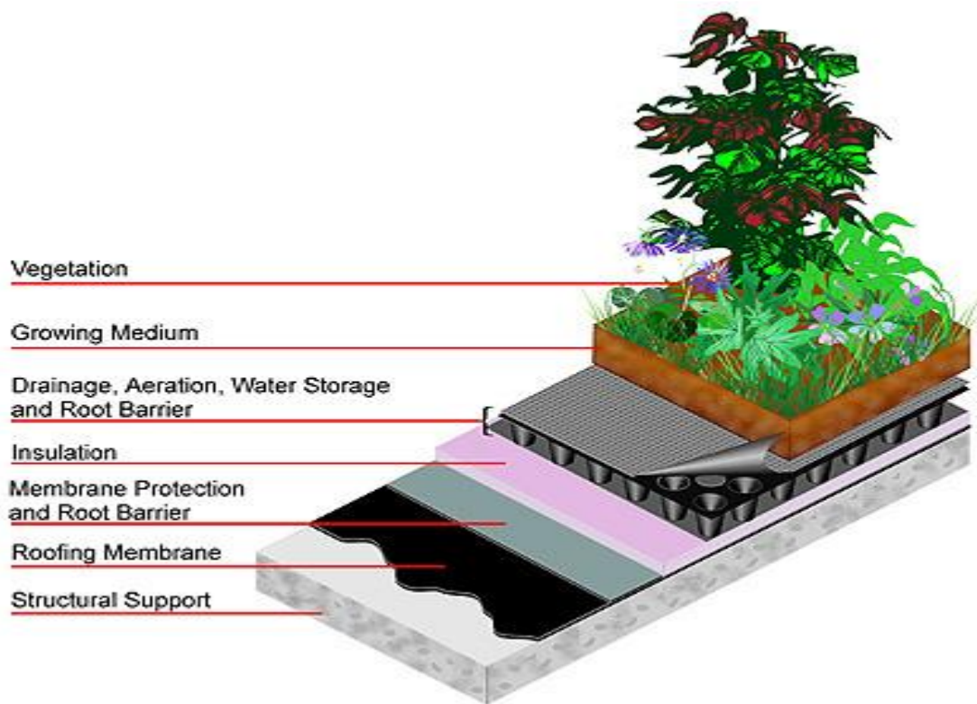
Εικόνα 22: Στρώσεις φυτεμένου δώματος Πηγή: www.cleanerairforcities.blogspot.com
