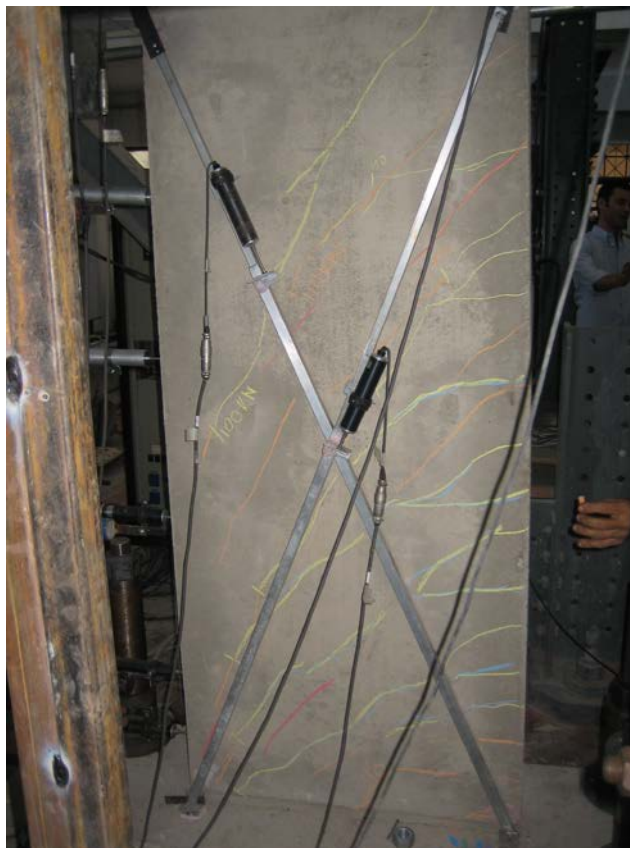
Σχήμα 6.15 Εξέλιξη της ρηγματώσης κατά την επιβολή φορτίου ίσου με 87% της φέρουσας ικανότητας (130kN, 25mm) του δοκιμίου.
