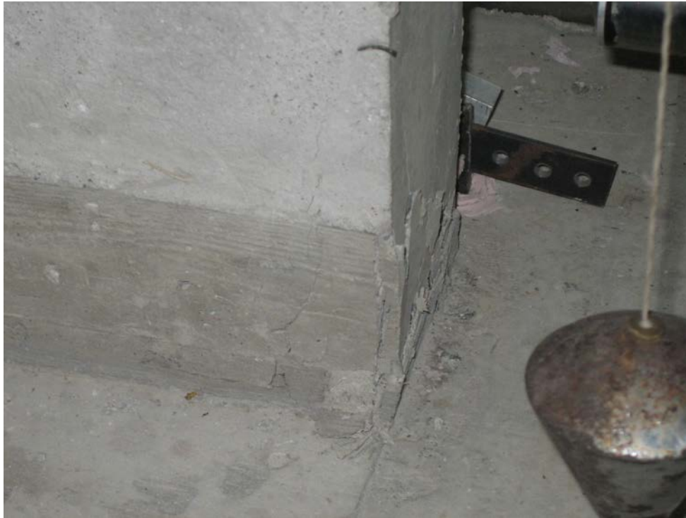
Σχήμα 6.15 Εξέλιξη της ρηγματώσης κατά την επιβολή φορτίου ίσου με 87% της φέρουσας ικανότητας (130kN, 25mm) του δοκιμίου.
