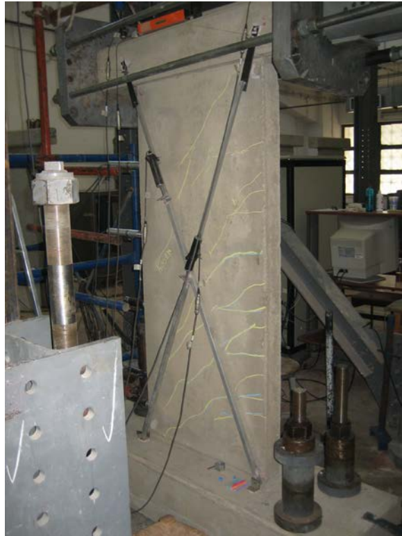
Σχήμα 6.14 Εξέλιξη της ρηγμάτωσης κατά την επιβολή φορτίου ίσου με 67% της φέρουσας ικανότητας (100kN, 14mm) του δοκιμίου.
