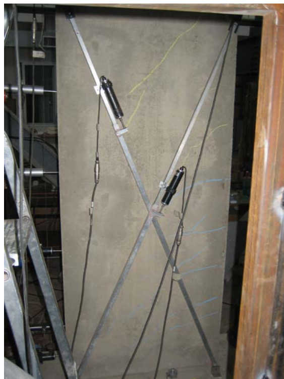
Σχήμα 6.12 Εξέλιξη της ρηγμάτωσης κατά την επιβολή φορτίου ίσου με 40% της φέρουσας ικανότητας (60kN, 8mm) του δοκιμίου.
