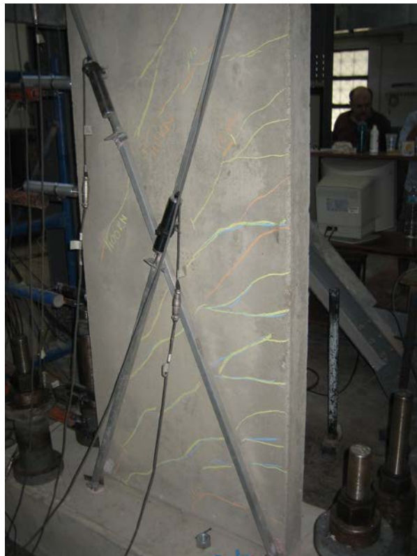
Σχήμα 6.14 Εξέλιξη της ρηγμάτωσης κατά την επιβολή φορτίου ίσου με 67% της φέρουσας ικανότητας (100kN, 14mm) του δοκιμίου.
