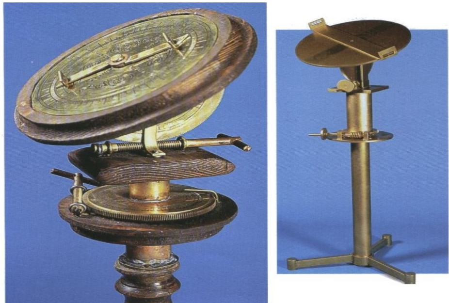
Εικ 34,35 Η γεωδαιτική δίοπτρα του Ήρωνα,( http://ellinon-pnevma.blogspot.com )
